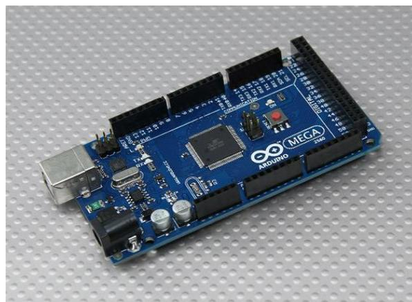
**Figura 53 – Microcontrolador Arduino ATmega 2560**
