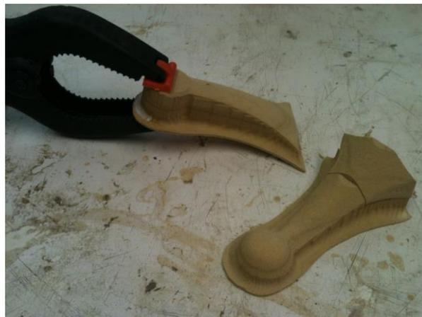
**Fotografia 8 – Colagem das partes dos braços**
