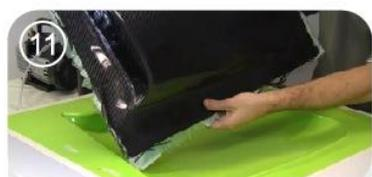
A peça é retirada do molde pronta para um acabamento final.
