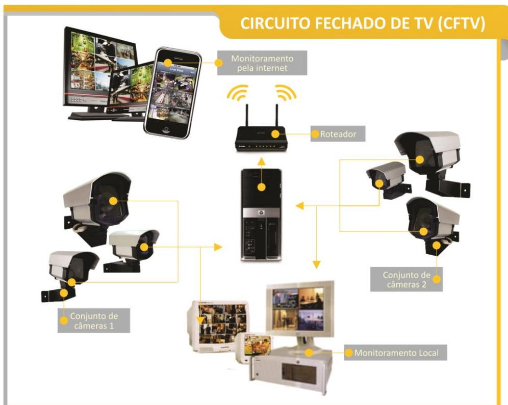
**Figura 9 – Circuito fechado de televisão (CFTV)**
