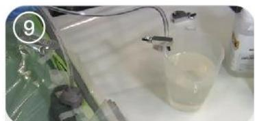
Após o ar ser todo retirado, o tubo que antes estava lacrado é então colocado dentro de um recipiente com resina. A resina é então puxada para dentro do molde lacrado graças ao vácuo.
