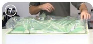
Após todas essas camadas o molde é então embrulhado dentro de um saco plástico e lacrado com as pontas dos “tubos de irrigação” para fora.
