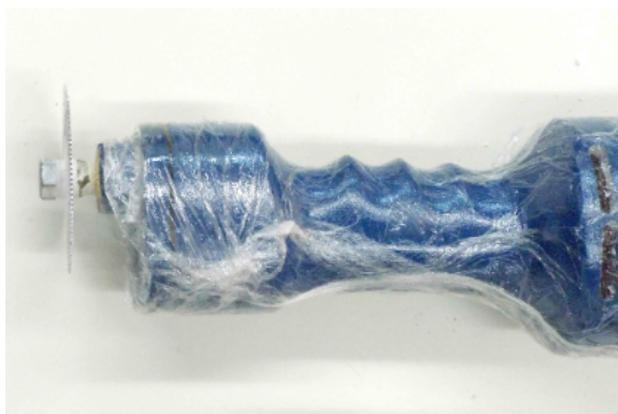
**Fotografia 4 - Cobrir a ferramenta com filme plástico**
