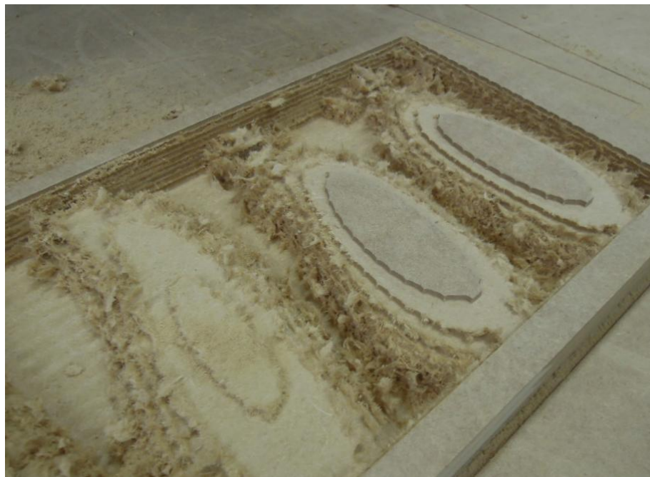
Figura 81 – Resultado da etapa de desbaste Fonte: Das autoras, 2013.
