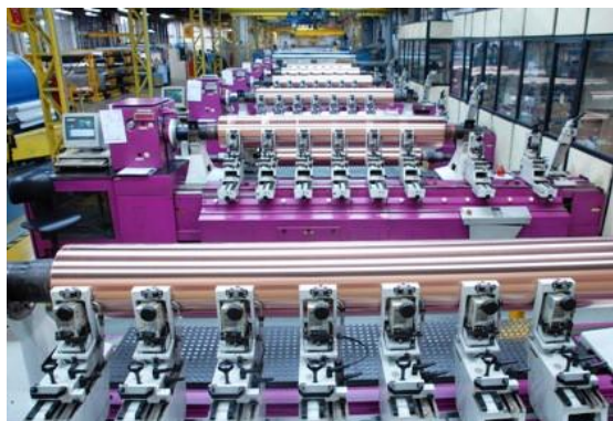
Figura 8 – Impressão em rotogravura Fonte: Gráfica Abril, 2012.
