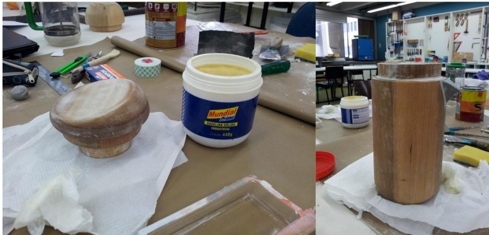
Figura 38 – Aplicação do desmoldante Fonte: As autoras (2013)
