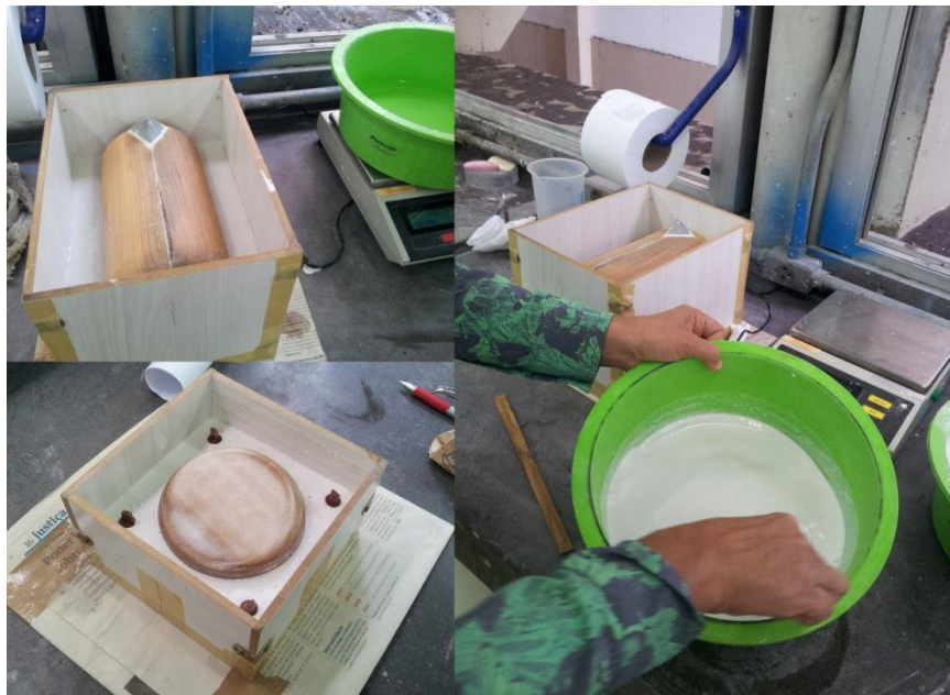
Figura 39 - Confeção do molde de gesso Fonte: As autoras (2013)
