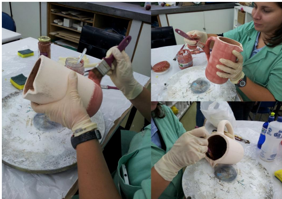
Figura 46 - Aplicação do esmalte com pincel Fonte: As Autoras (2013)
