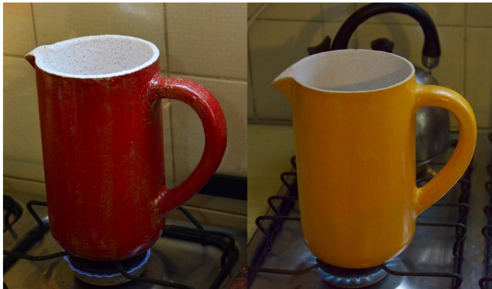
Figura 51 - Teste de resistência térmica Fonte:As Autoras (2013)
