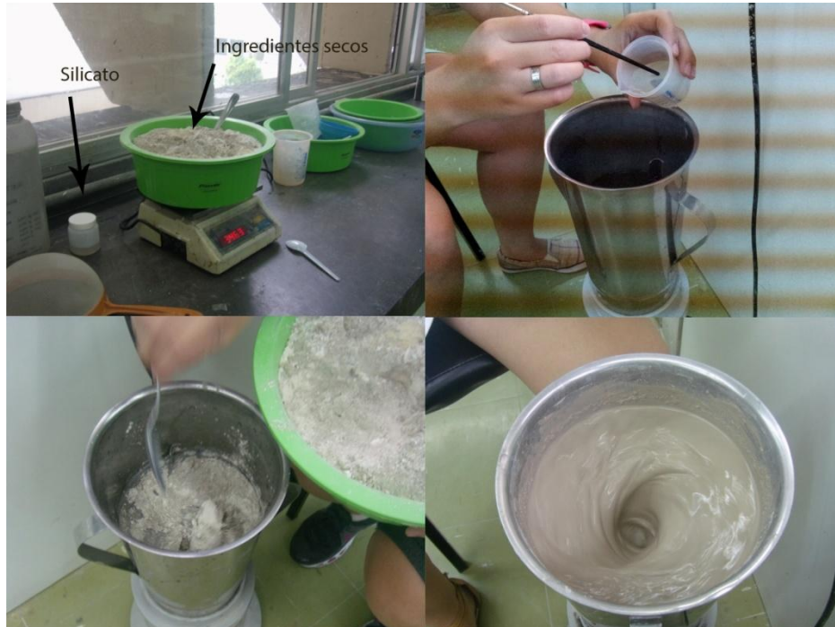
Figura 40 - Etapas para fabricação de barbotina Fonte: As Autoras (2013)
