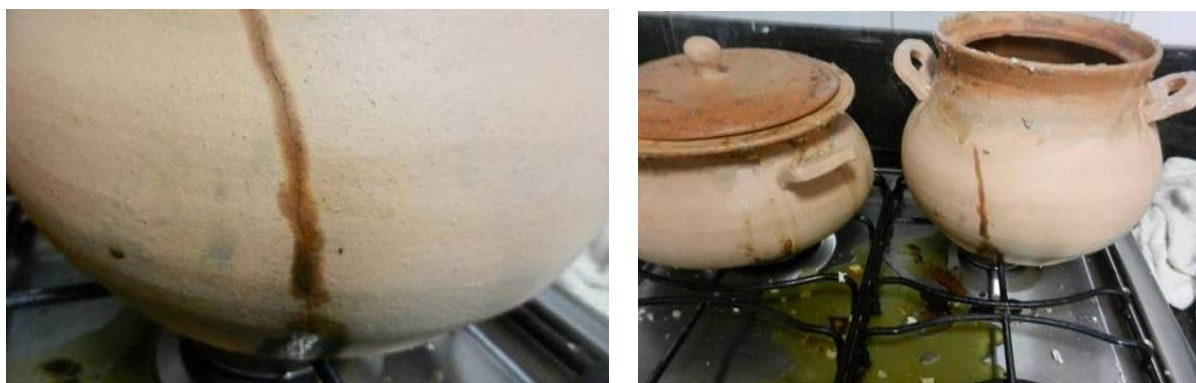
Figura 32 - Rachadura na panela, após preparo do barreado Fonte: As Autoras (2012).
