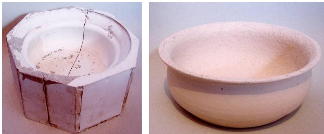
Figura 87 - Molde bipartido e peça com massa térmica Fonte: As Autoras (2013).
