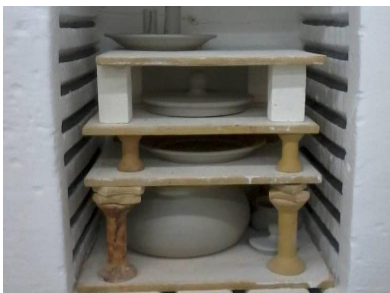
Figura 45 - Peças dentro do forno, para primeira queima Fonte: As Autoras (2013).
