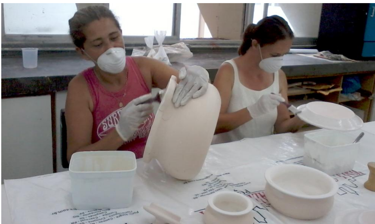
Figura 49 - Aplicação de esmalte por artesãs Fonte: As Autoras (2013).
