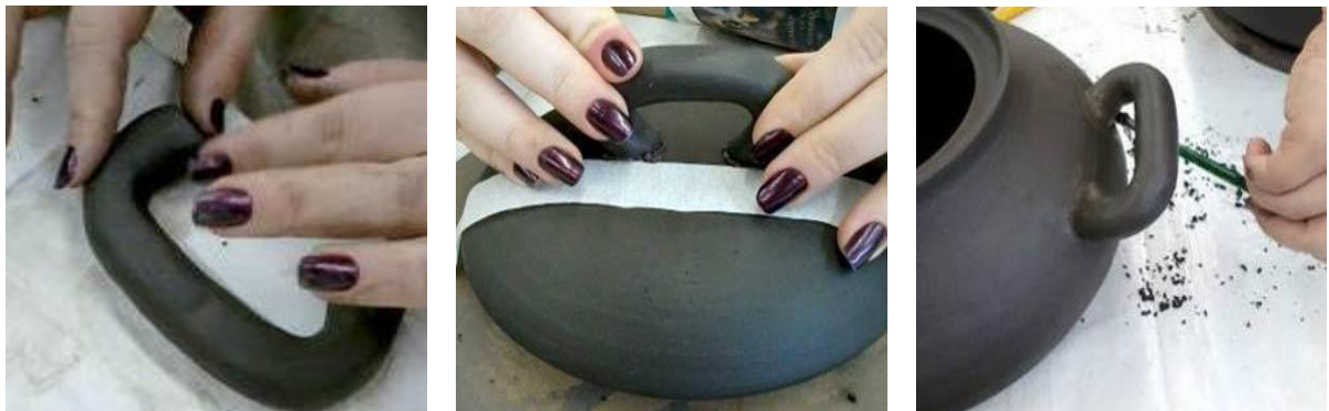
Figura 23 - Modelagem e colagem das alças e pegadores Fonte: As Autoras (2012).
