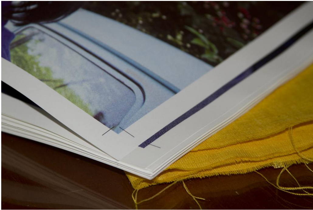
Figura 89. Cruzes de corte e sangra, antes do acabamento final. Fonte: os autores
