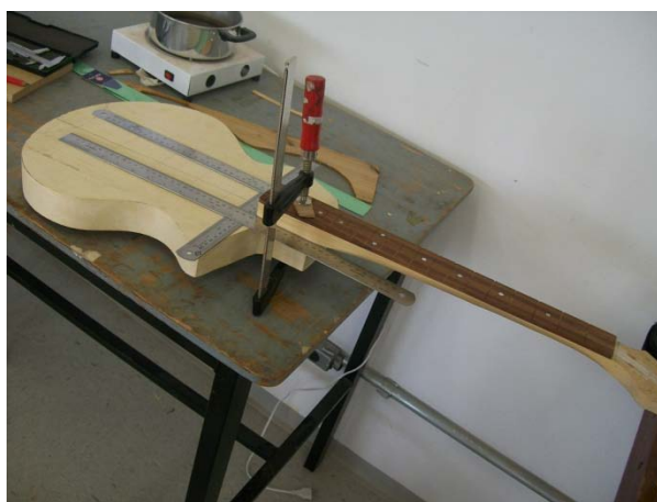
Figura 59 – Montagem do braço com o corpo
