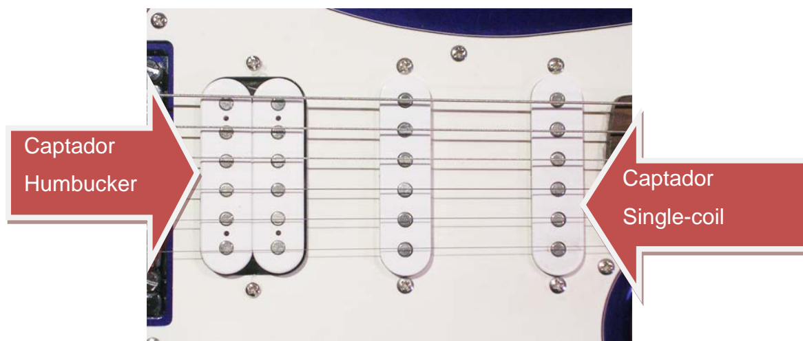
Figura 7 - Guitarra com dois captadores single-coil e um humbucker . Fonte: Wikisources, 2010
