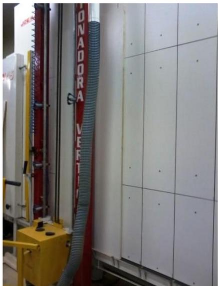
**Figura 36 - Corte Vertical das Chapas**
