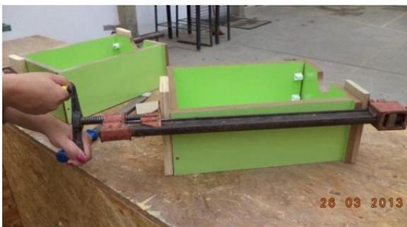
**Figura 58 - Sargento para fixação**
