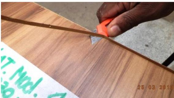
**Figura 53 - Retirada das Rebarbas**
