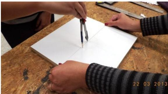
**Figura 40 - Marcação dos Cortes Circulares**
