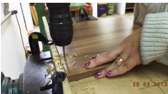
**Figura 42 - Furação dos Parafusos**
