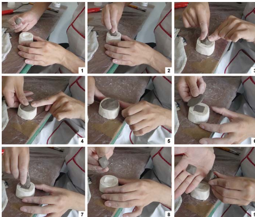
Figura 56 - Processo de produção por prensa manual Fonte: A Autora (2012).
