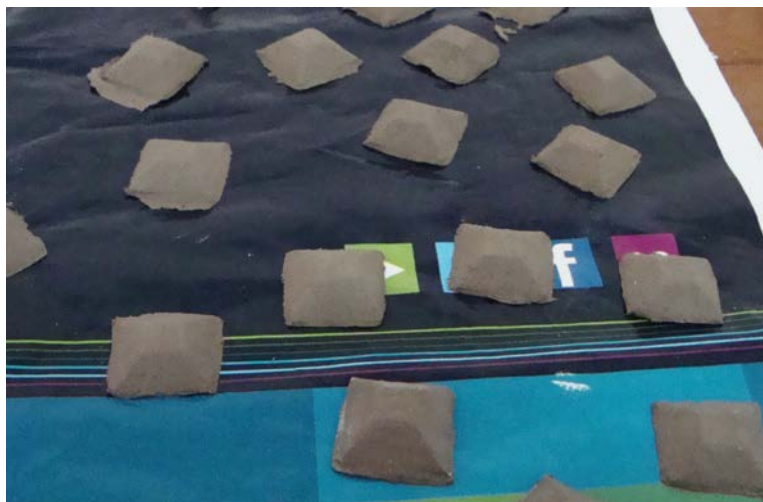
Figura 57 - Pingentes do conjunto 1 após modelagem por prensa manual sem acabamento Fonte: A Autora (2012).
