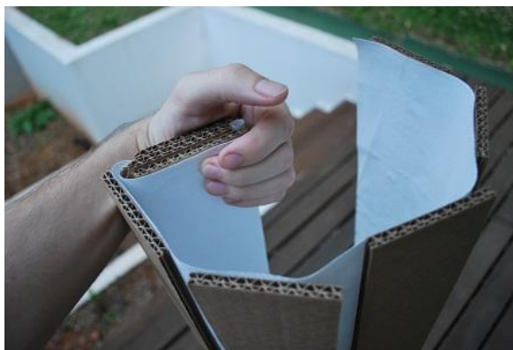
Figura 59 – Teste de dobra do material Fonte: Fotografado por Diego Mafioletti (2011).
