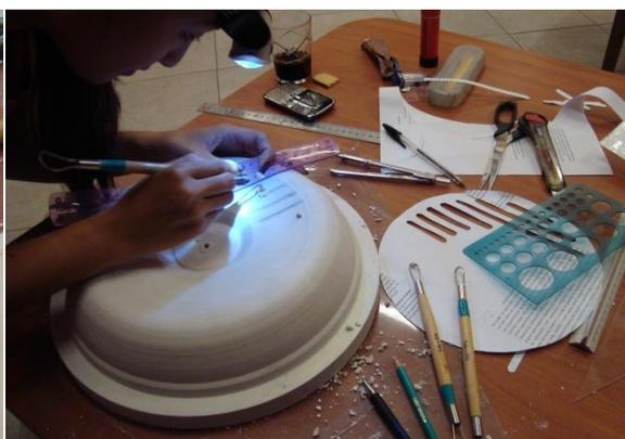
**Figura 112 - Desbaste do molde da grelha**
