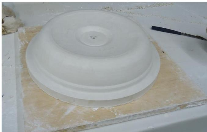
**Figura 110 - Molde da superfície da grelha perfilada**
