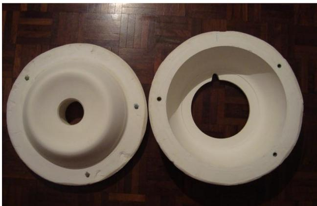
**Figura 81 - Molde da base da panela**
