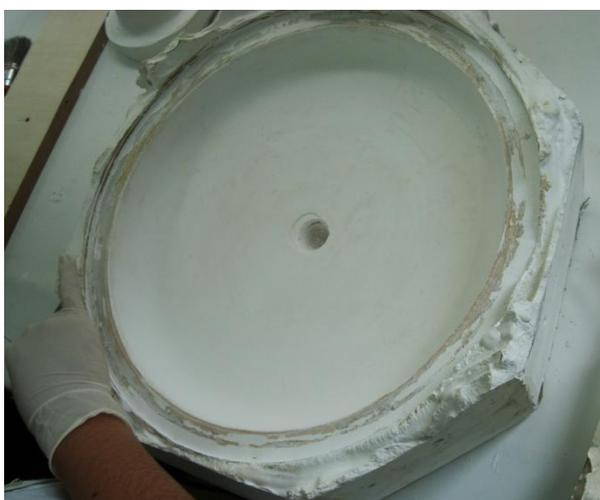
**Figura 115 - Molde da tampa perfilado**
