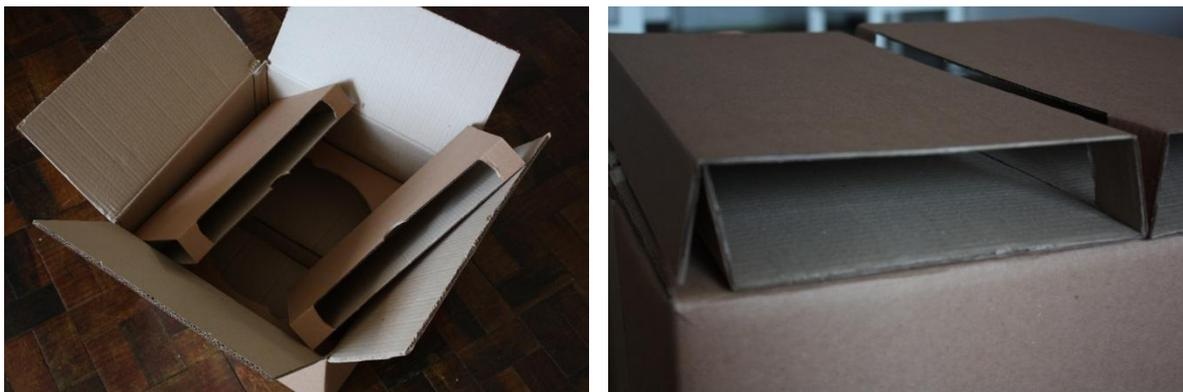
Figura 171 - Berço superior montado dentro da caixa de embalagem
