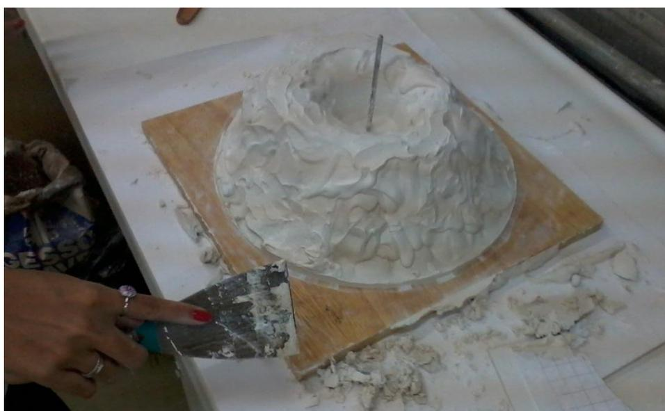
**Figura 103 - Retirada de gesso acumulado na base do perfilamento**
