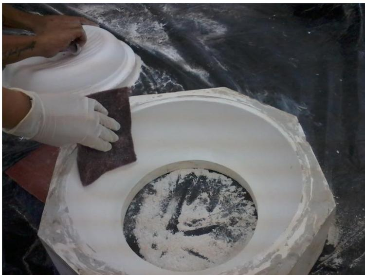
**Figura 119 - Acabamento dos moldes por lixamento**
