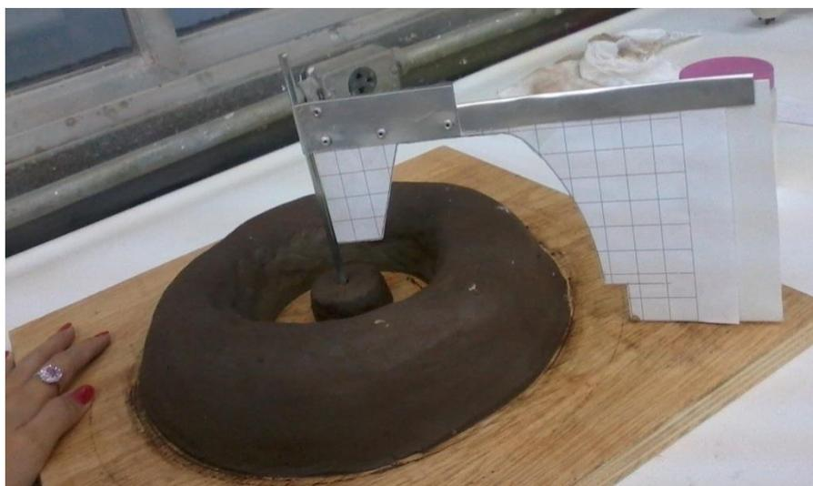
**Figura 100 - Argila colocada na base sob o perfil**
