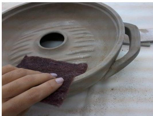
**Figura 142 - Acabamento da borda da panela**
