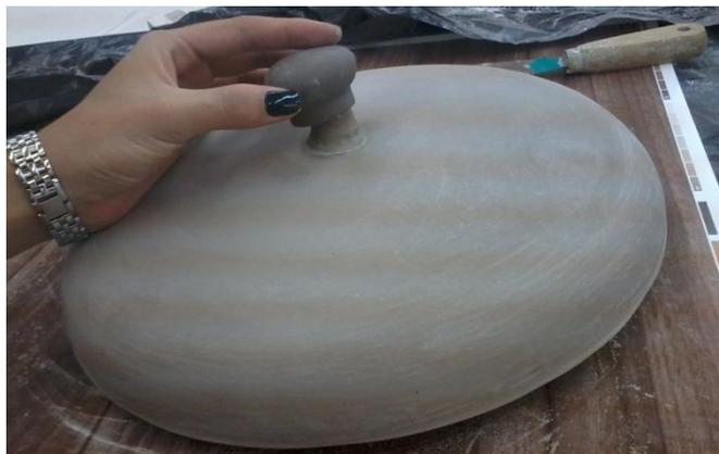
**Figura 140 - Pegador sendo fixado na tampa da panela**
