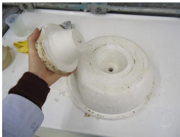
**Figura 109 - Molde do cone central da panela**
