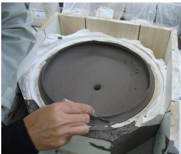
**Figura 138 - Tampa da panela após vertida**
