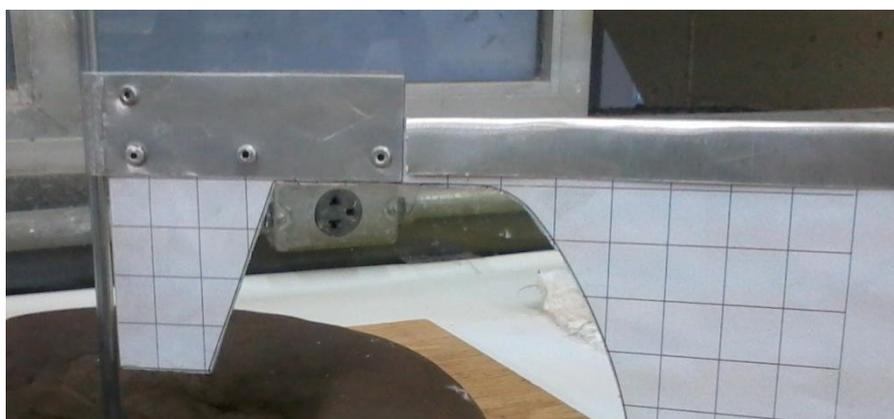
**Figura 96 - Fixação do perfil ao eixo**
