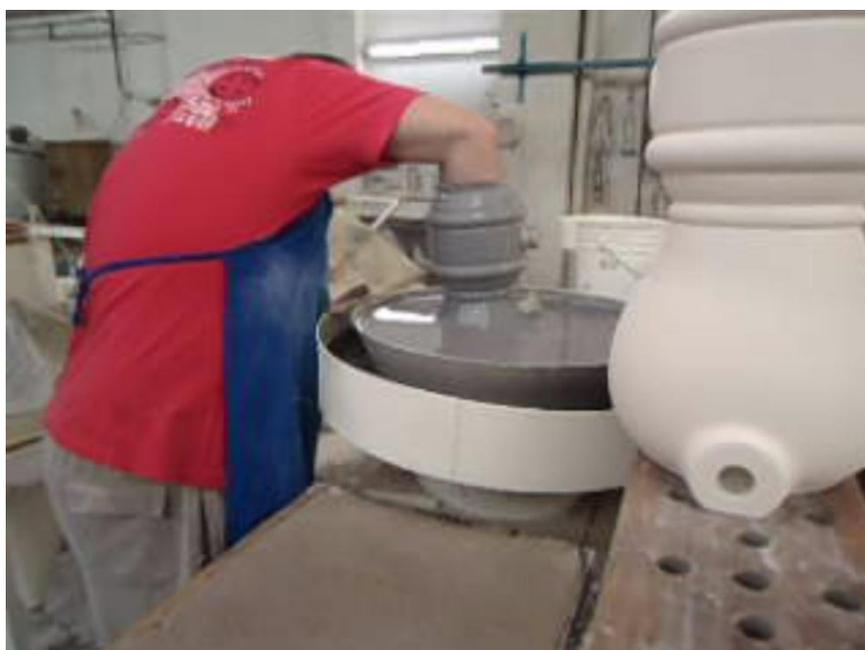
**Figura 17 - Funcionário imergindo peça em recipiente com esmalte**
