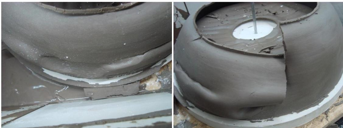
**Figura 131 - Peças deformadas após retirada do molde**
