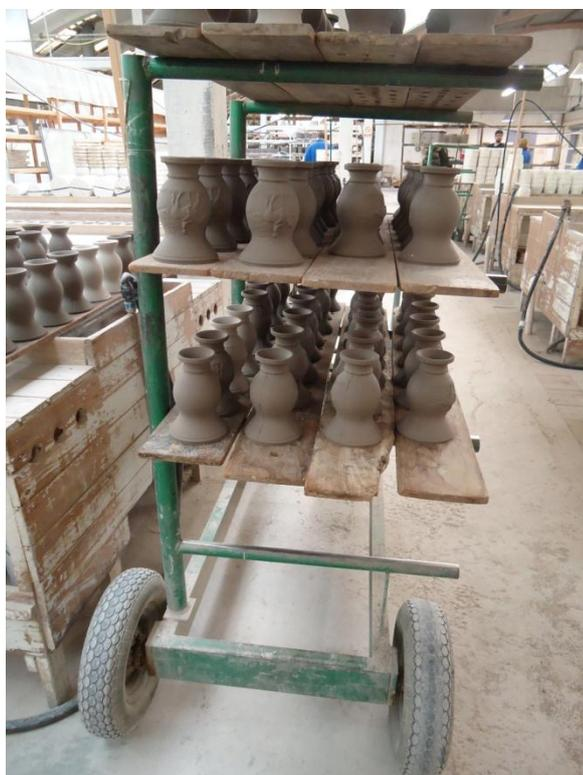
**Figura 20 - Carrinho de carga contendo peças recém retiradas dos moldes**
