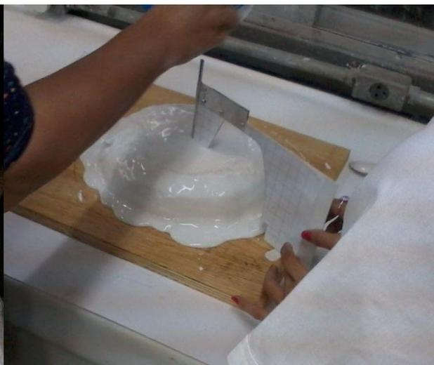
**Figura 102 - Perfilamento do gesso**
