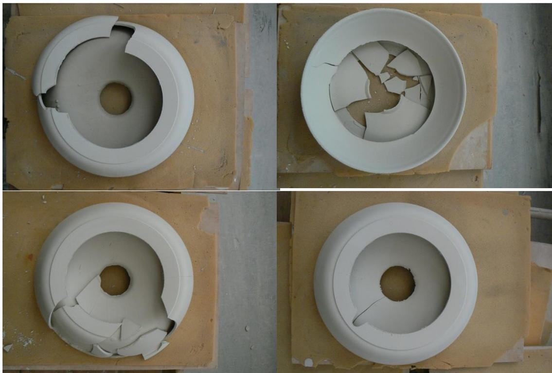
**Figura 88 - Peças danificadas durante processo de secagem**
