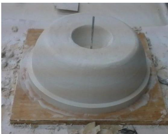
**Figura 105 - Modelo de superfície externa**
