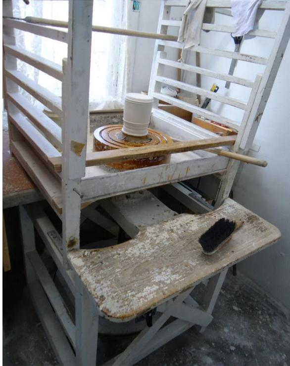
**Figura 9 - Torno de gesso com modelo afixado**
