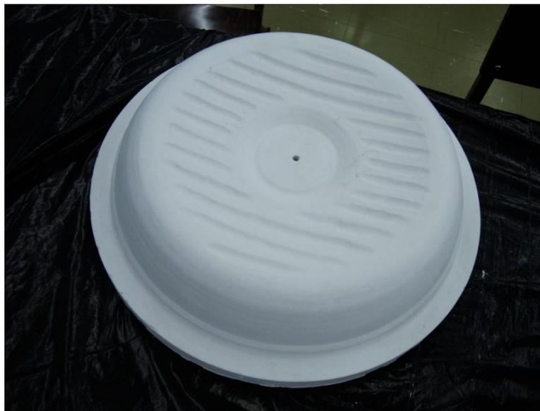
**Figura 113 - Molde da superfície da grelha finalizada**
