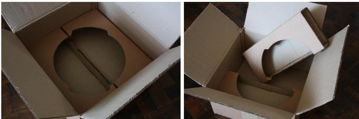
**Figura 169 - Berço inferior montado dentro da caixa de embalagem**
