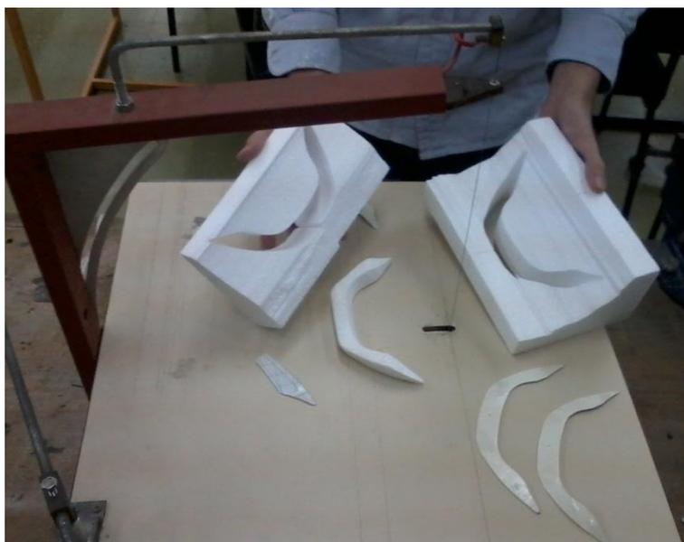
**Figura 117 - Recorte do modelo das alças em isopor**
