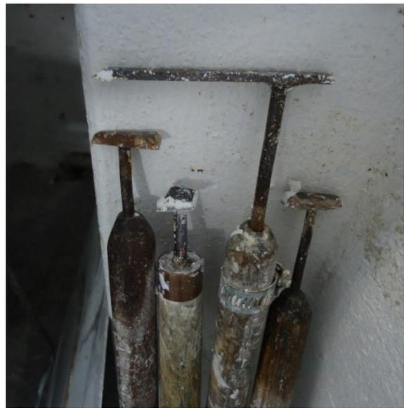
**Figura 11 - Ferramentas de desbaste**
