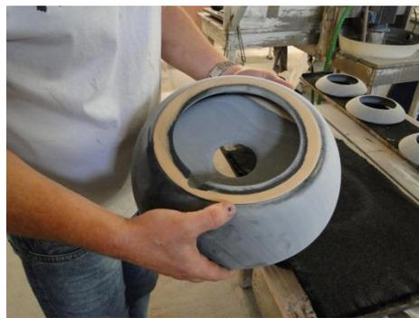
**Figura 90 - Retirada de esmalte da base da peça**
