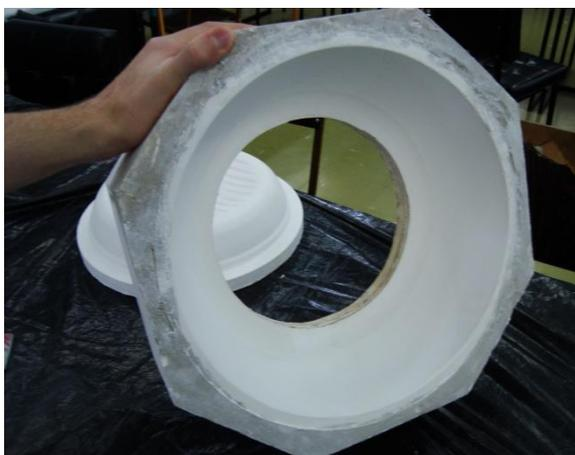
**Figura 108 - Molde da lateral da panela**
