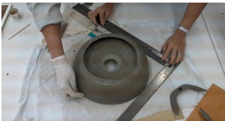
**Figura 136 - Marcação dos pontos de fixação das alças**
