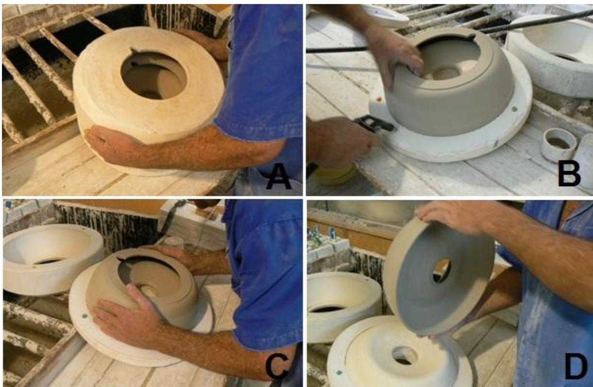
**Figura 86 - Sequência de retirada da peça do molde**
