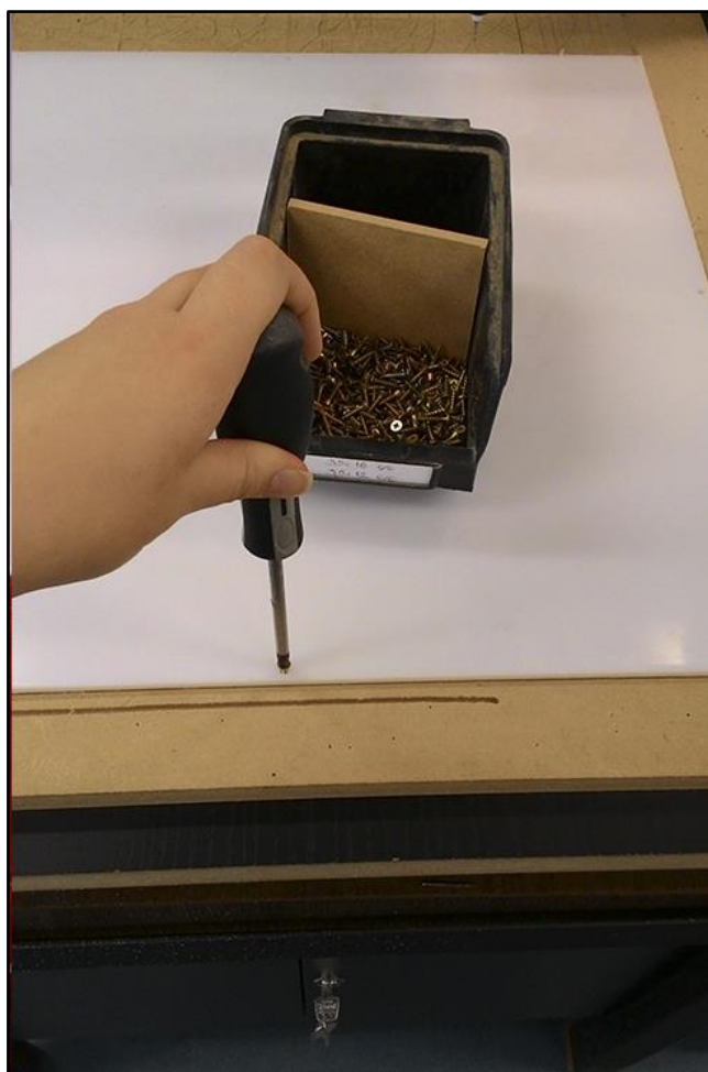
Figura 47 - Processo de fixação da chapa na fresadora CNC Fonte: Autoria própria (2015)
