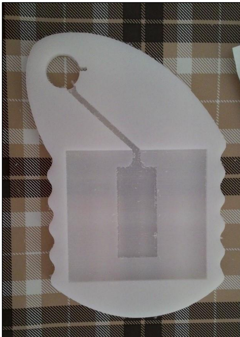
Figura 42 - Peça de PEAD usinada durante o segundo teste Fonte: Autoria própria (2015)
