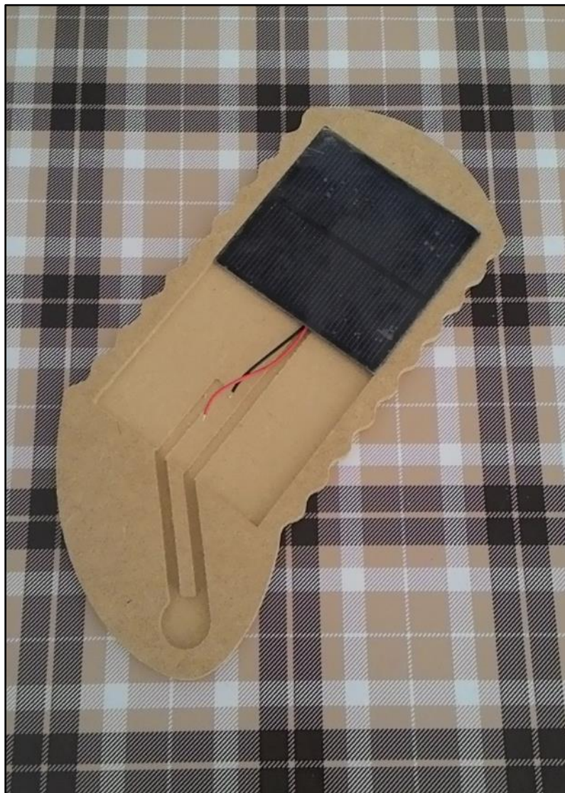
Figura 40 - Verificação da adequação do tamanho da peça usinada em relação às células fotovoltaicas Fonte: Autoria própria (2015)
