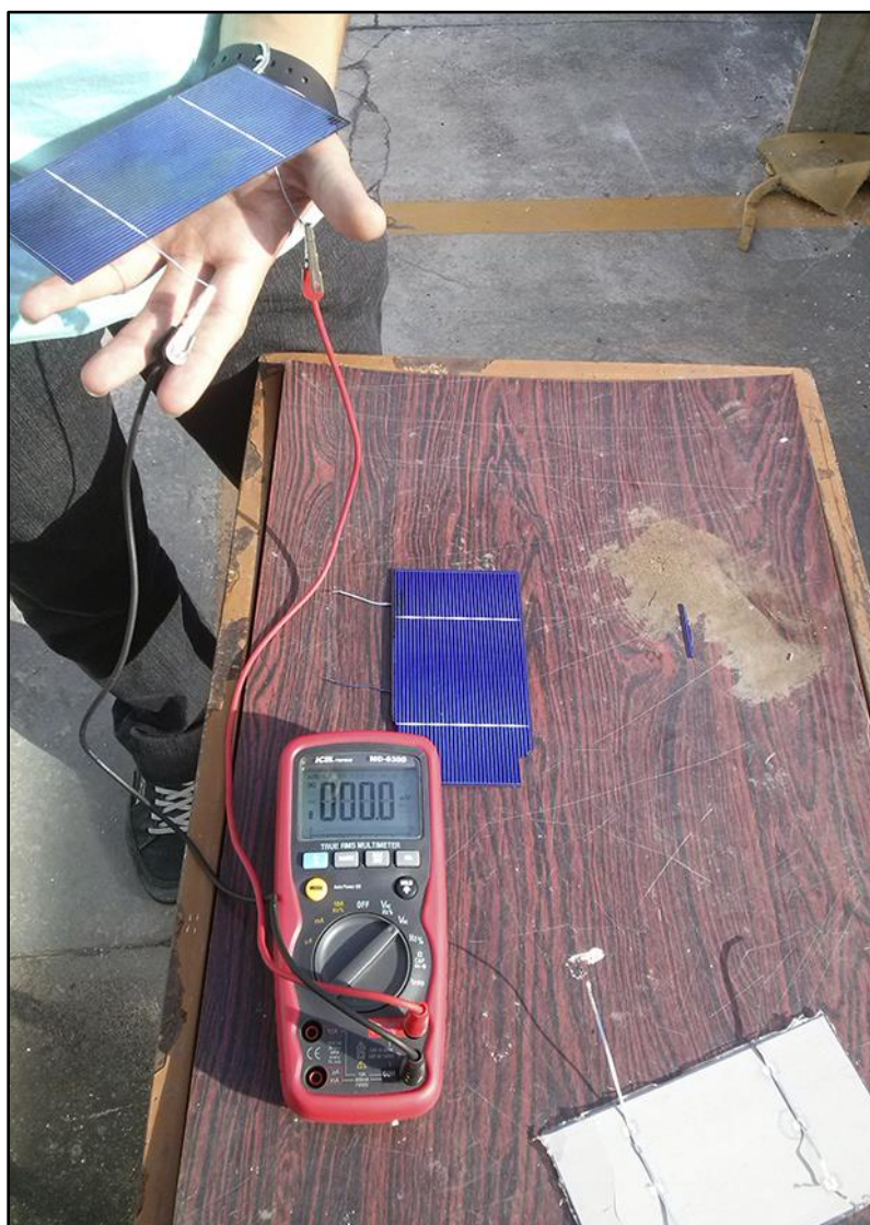
Figura 34 - Teste com as células fotovoltaicas com defeito, utilizando um multímetro Fonte: Autoria própria (2015)
