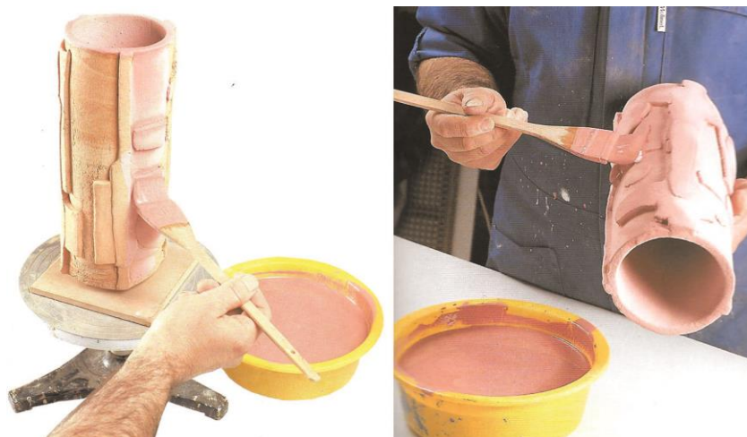
Figura 39 - Técnica de esmaltação com pincel Fonte: Chavarria, 2004
