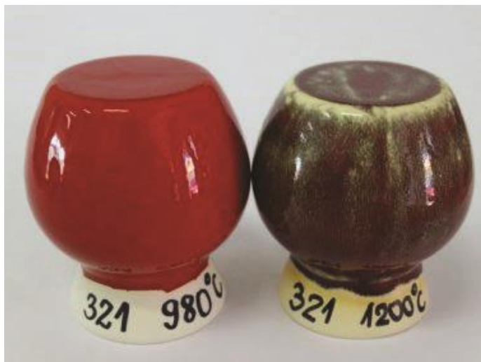
Figura 31 – Mesmo esmalte em temperaturas diferentes Fonte: Casa do ceramista, 2015
