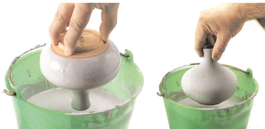
Figura 37 - Técnica de esmaltação por imersão ou mergulho Fonte: Chavarria, 2004
