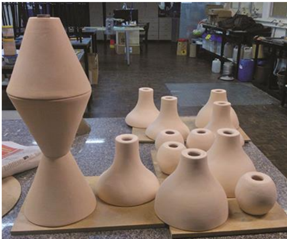
Figura 71 – Peças após primeira queima - biscoito Fonte: Autoria própria, 2015
