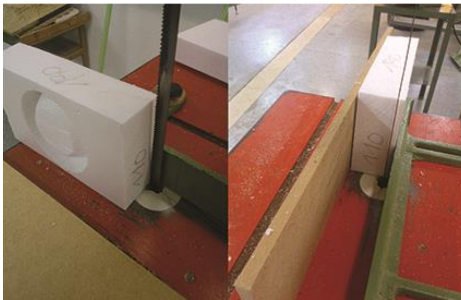
Figura 64 - Corte da sobra de material do bloco de isopor Fonte: Autoria própria, 2015
