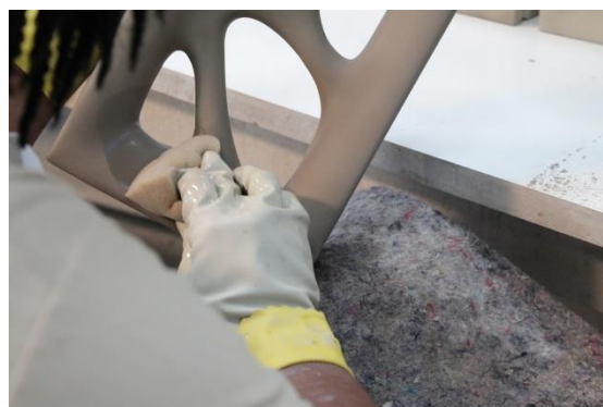
Figura 44 - Acabamento com esponja molhada Fonte: Daiane Cavallari, 2015
