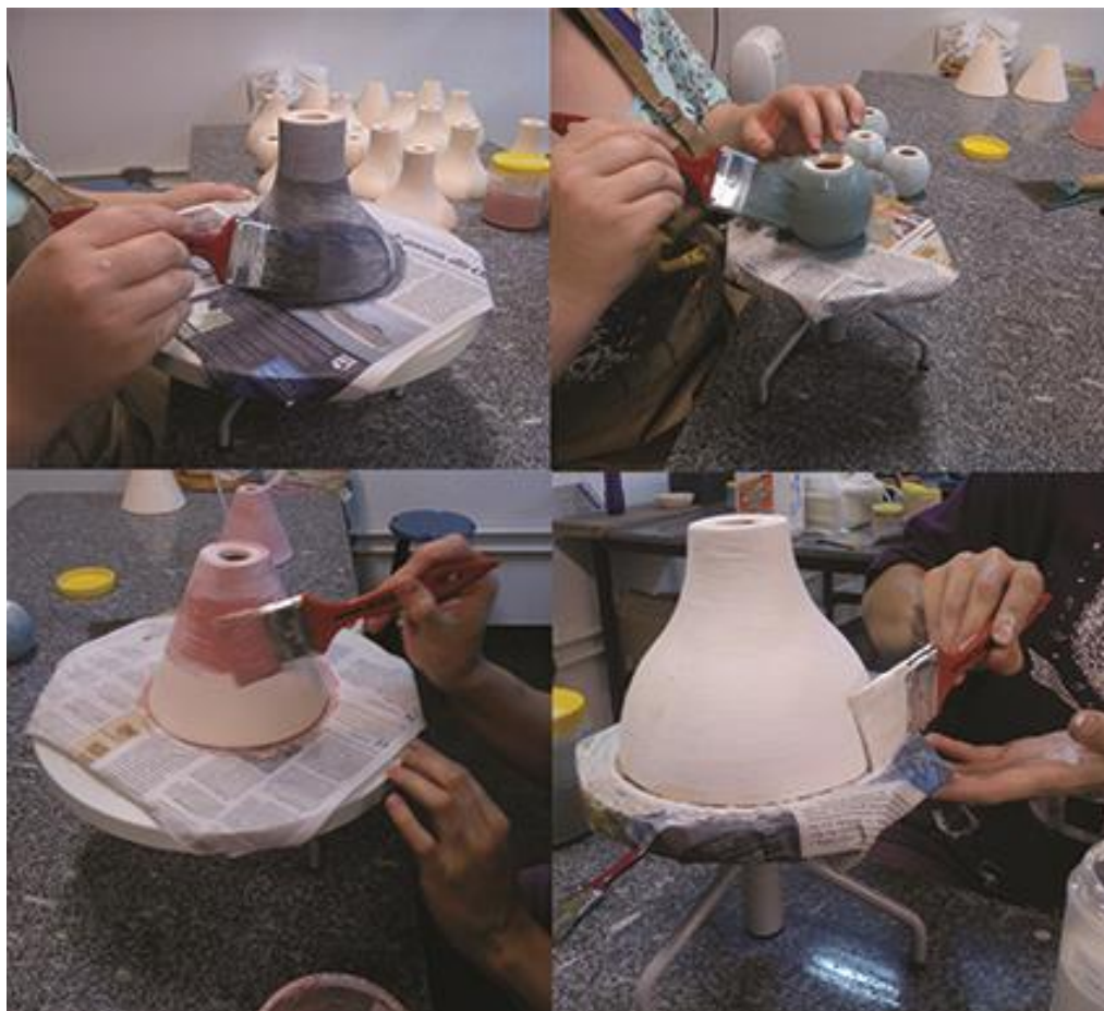
Figura 75 - Processo de esmaltação Fonte: Autoria própria, 2015
