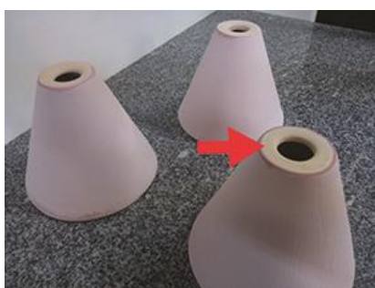
Figura 76 - Parte da peça não esmaltada Fonte: Autoria própria, 2015
