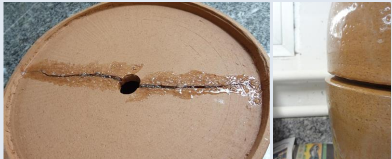
Rachadura com resina e retração entre as peças
