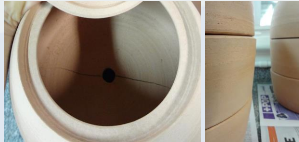
Rachadura e retração
