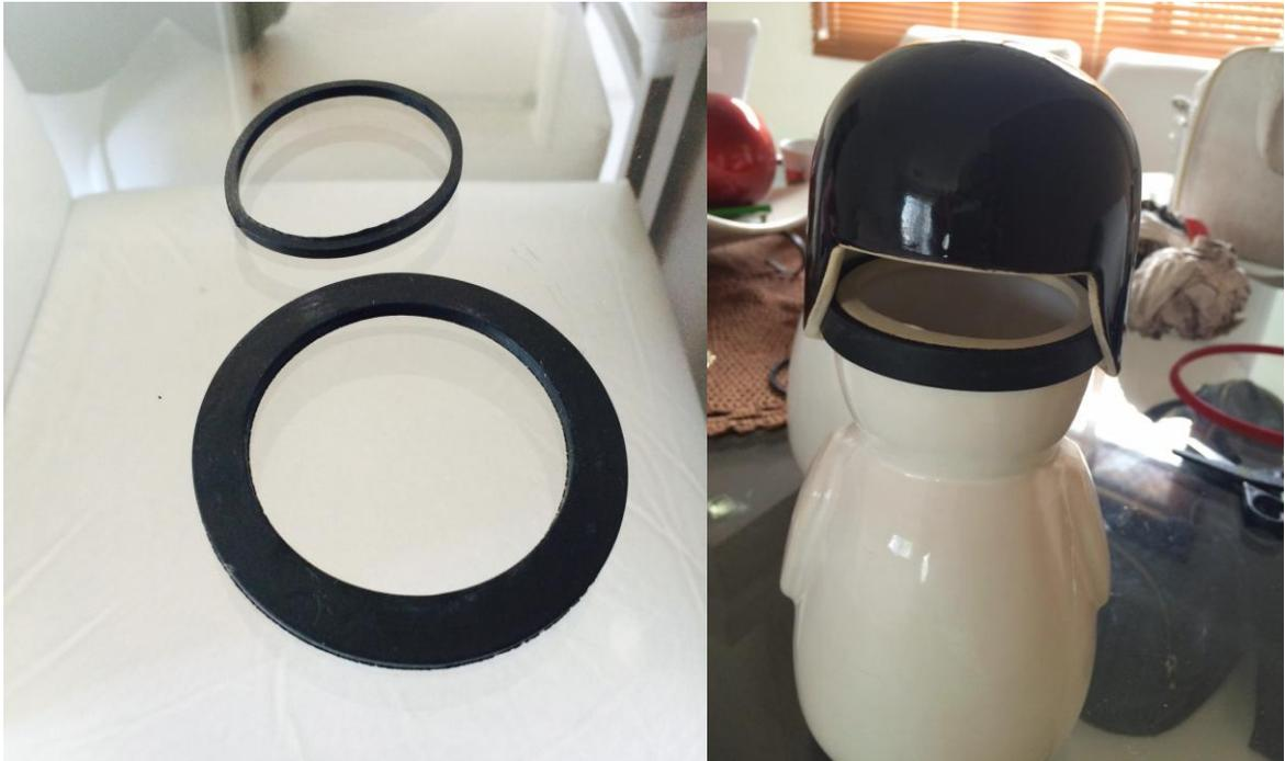
**Figura 47 - Teste com anel de vedação no corpo do pote.**
