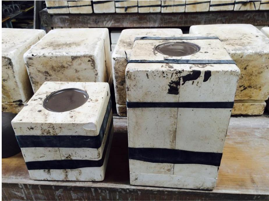
**Figura 34 - Moldes de gesso do corpo e da tampa**
