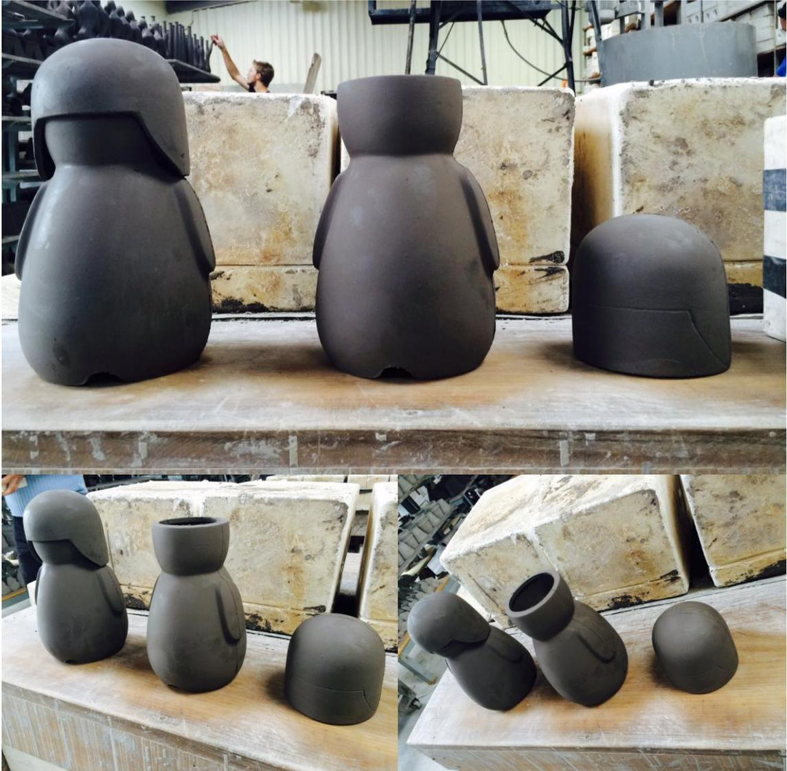
**Figura 36 - Peças após desmoldagem**
