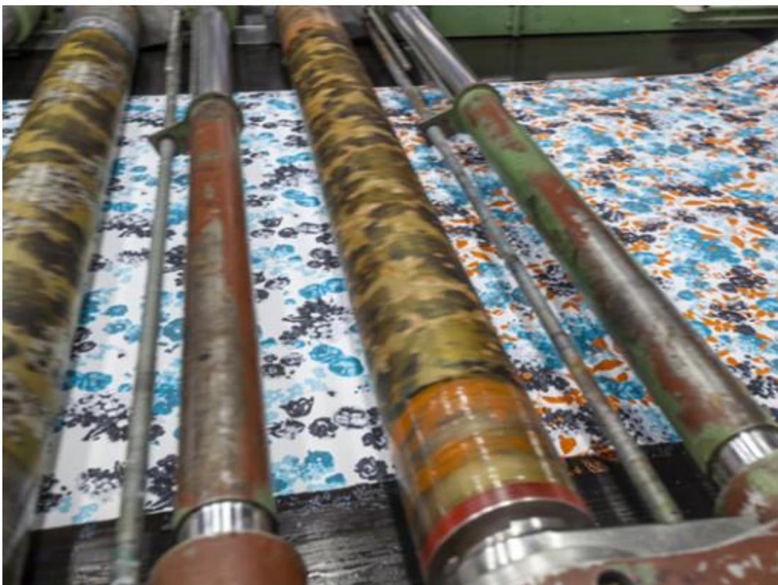
**Figura 26 – Processo de estamperia rotativa utilizando 2 cilindros.**
