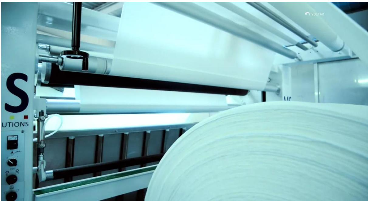
**Figura 28 – Colocação do tecido na máquina, rolos ao longo de sua extensão mantém o tecido esticado até a área de impressão.**
