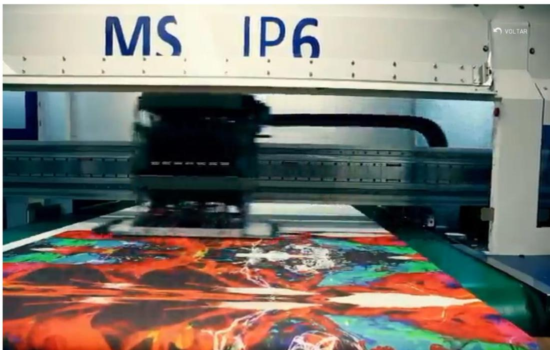
**Figura 29 – Área de impressão da impressora a jato de tinta.**
