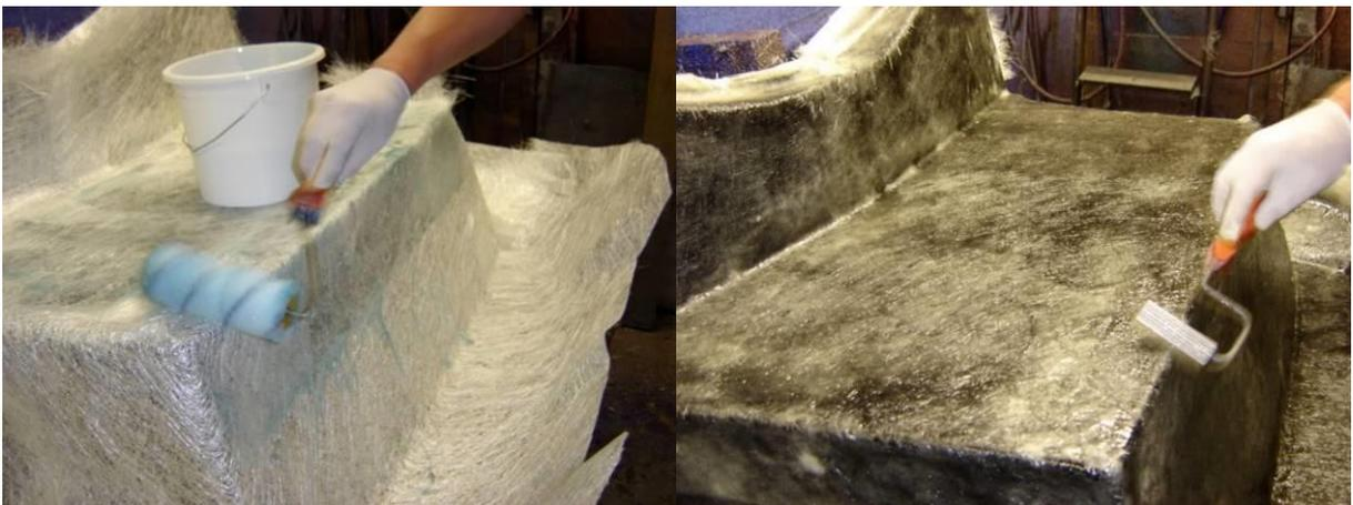
**Figura 34 - Impregnação manual e remoção de ar com rolete**
