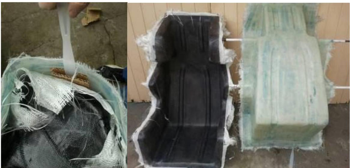
**Figura 60 - Desmoldagem do protótipo**
