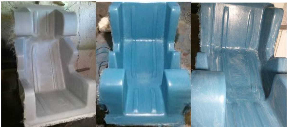
**Figura 53 - Conclusão da pintura PU e aplicação da massa de polimento**
