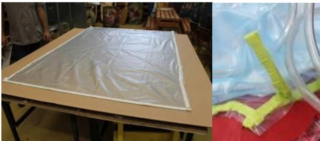
**Figura 84 - Aplicação da Tacky tape na bolsa e detalhe da aplicação no molde**
