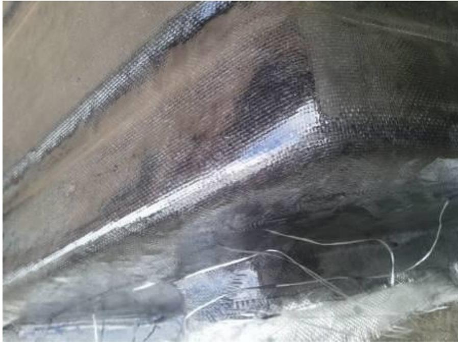
**Figura 59 - Superfície do molde após laminação manual**
