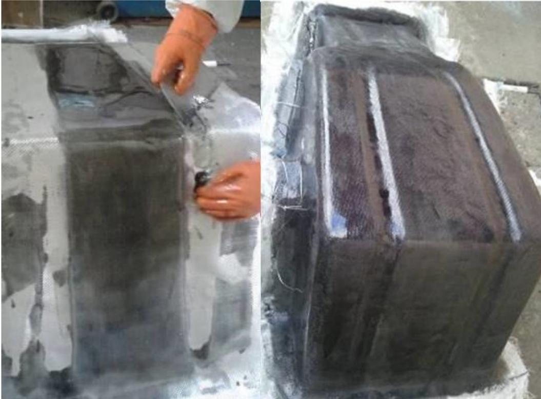
**Figura 57 - A. Laminação manual. Trabalho de remoção de ar e promoção de contato da matriz e reforço, B. também imagem após conclusão**
