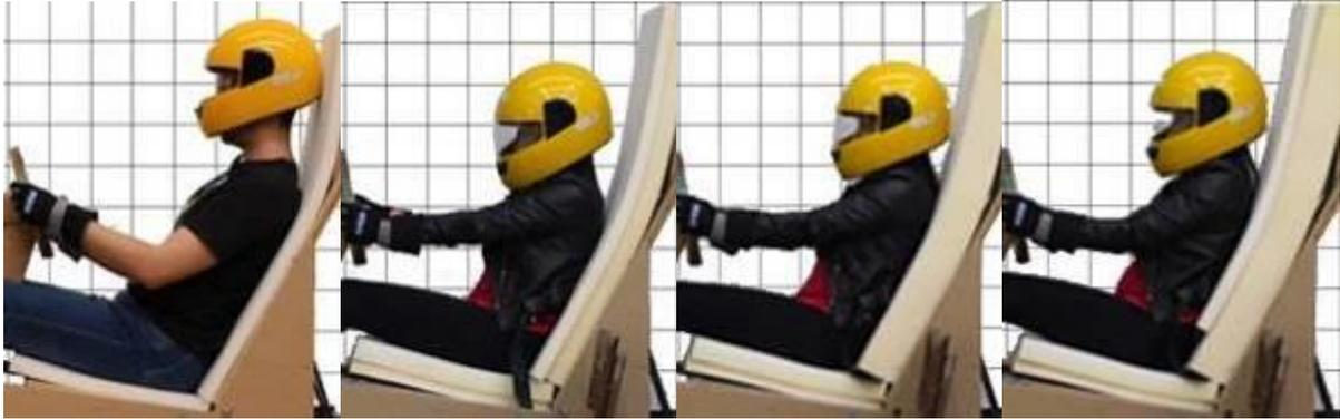
**Figura 39 - Alteração da espessura da espuma durante teste (encosto) de 30 até 130 mm**
