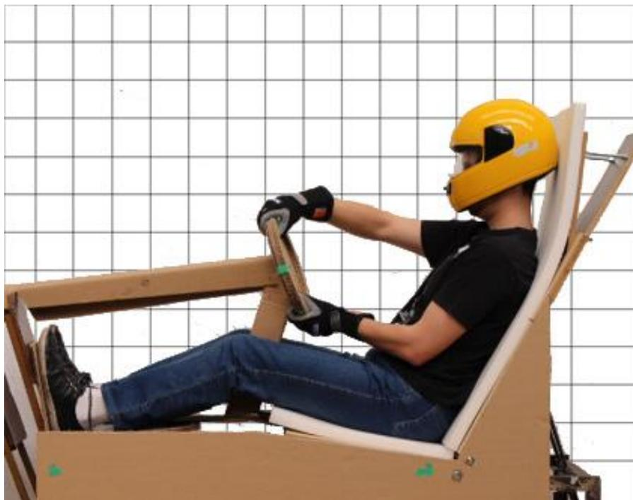
**Figura 40 - Análise ergonômica no movimento de esterçar o volante**
