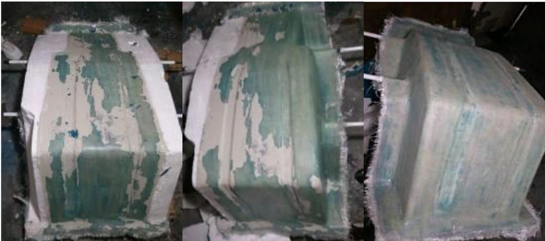
**Figura 56 - Desmoldagem do molde, desmontagem do modelo**
