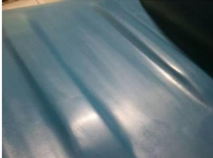
**Figura 55 - Superfície com desmoldante aplicado**
