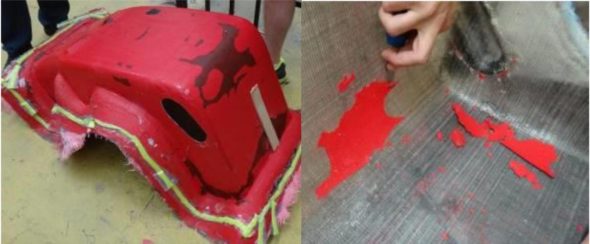
**Figura 90 - Detalhes do molde e protótipo 2 desmoldado e limpeza**
