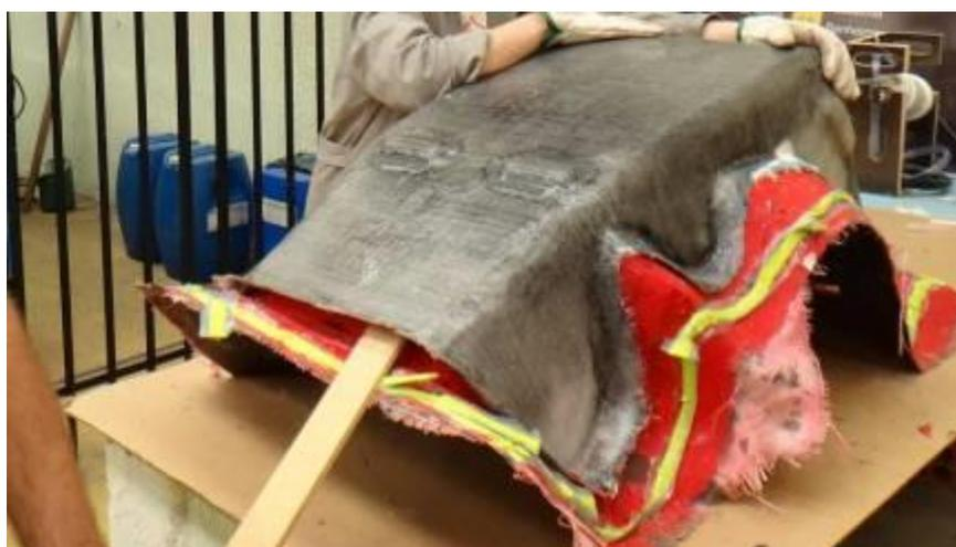
**Figura 89 - Uso de cunhas cumpridas para desmoldagem**
