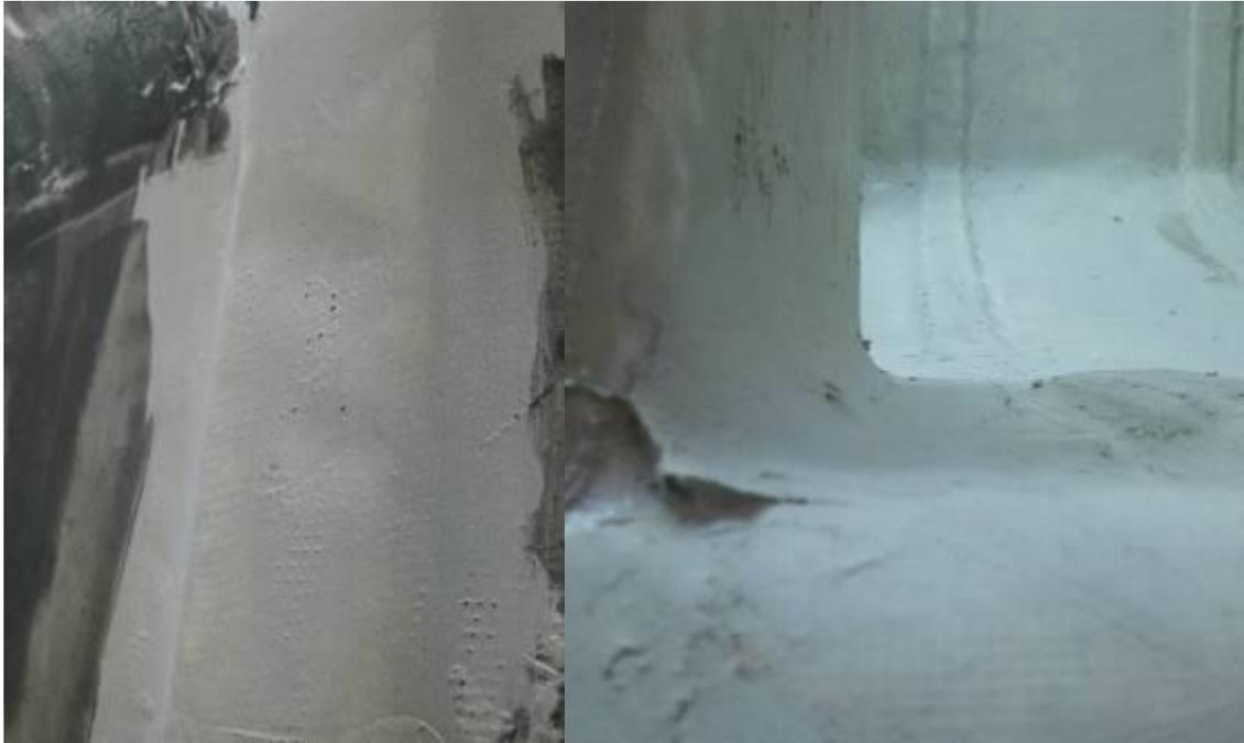
**Figura 54 - Problemas na construção do modelo do molde, perda de cantos e poros**
