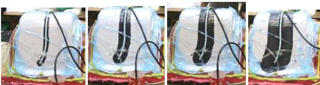
**Figura 86 - Avanço da resina sobre a superfície do molde**
