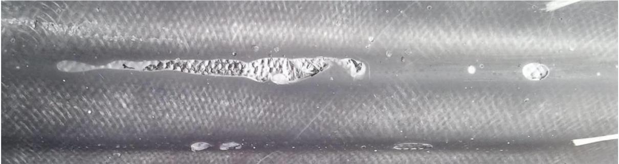
**Figura 61 - Falhas na superfície do protótipo**
