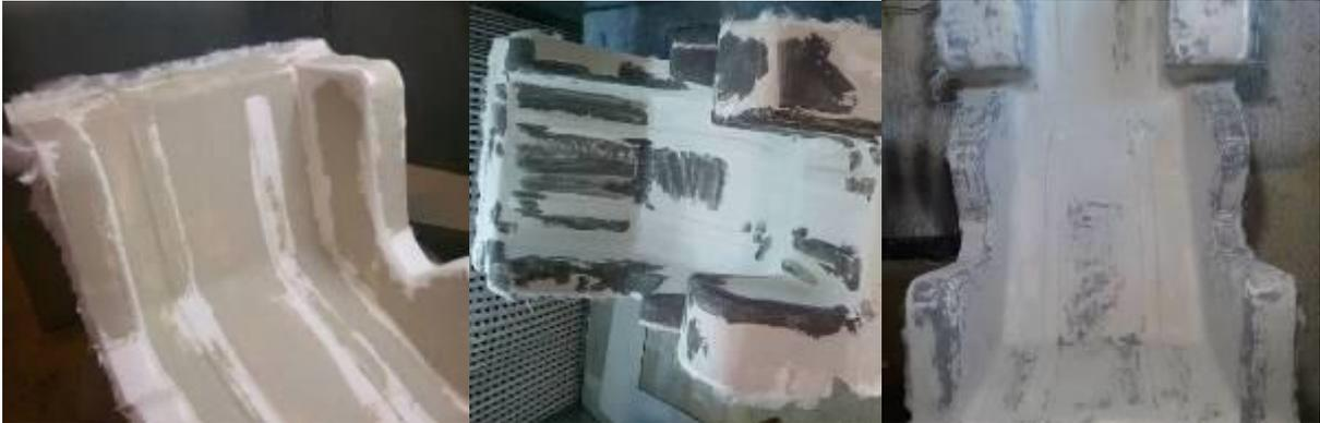
**Figura 52 - Sequência de aplicação de massa poliéster, massa rápida e lixamento final**
