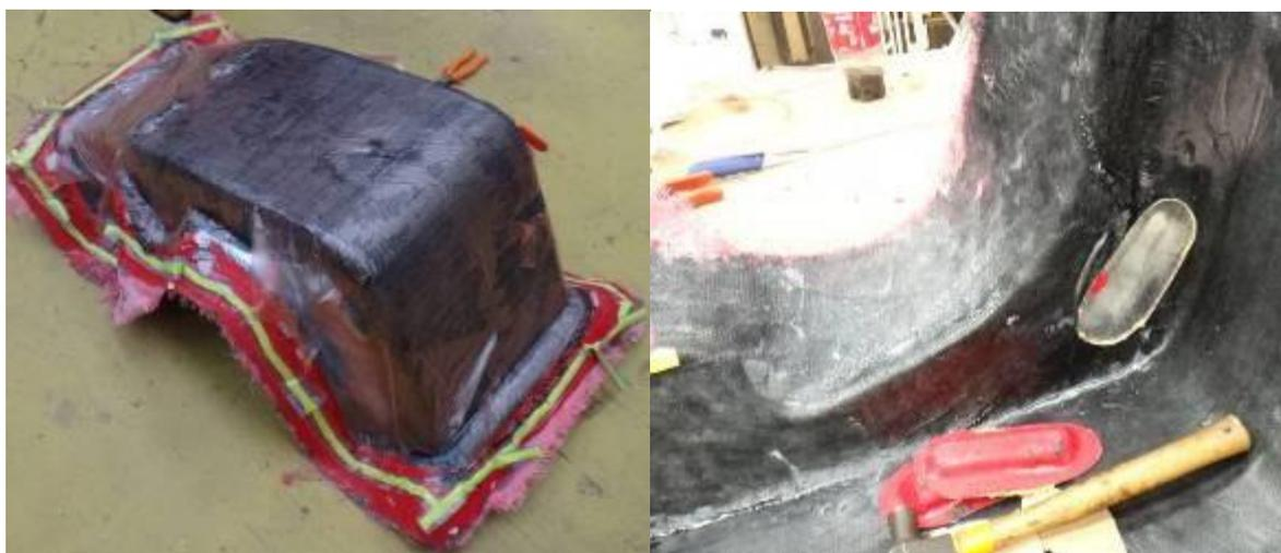
**Figura 88 - Desmoldagem das entradas dos cintos e remoção de material descartável**
