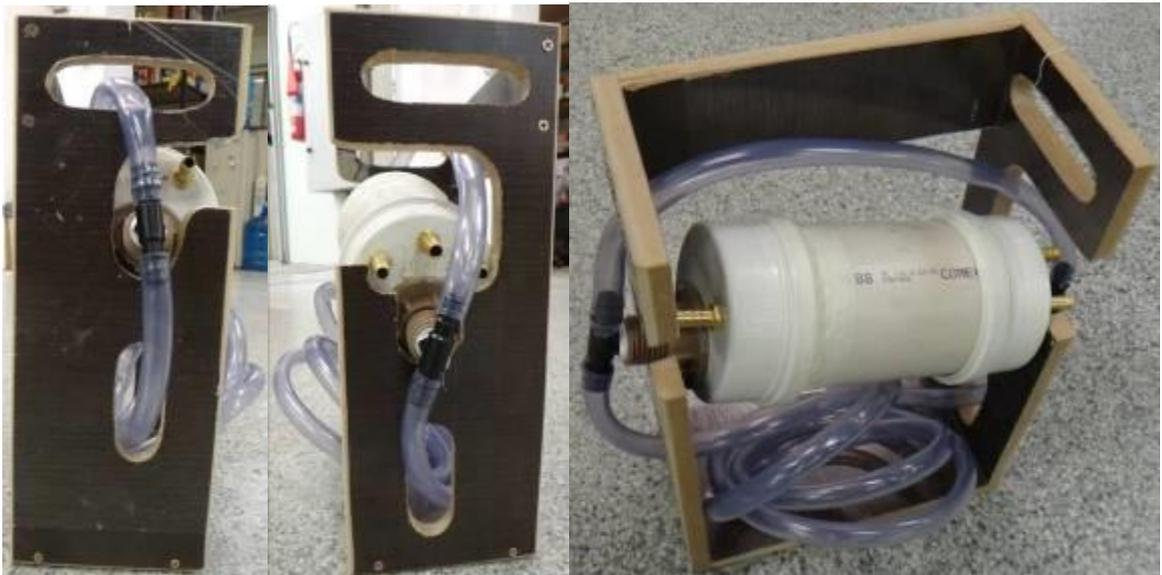
**Figura 79 - Vistas gerais do sistema de coleta de resina, com detalhe para inclinação do tubo**
