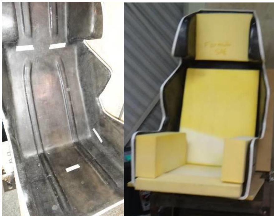
**Figura 62 - Marcação da passagem dos cintos e colocação das espumas**
