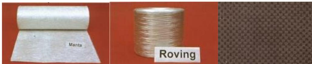
**Figura 24 - Tipos de orientação das fibras**
