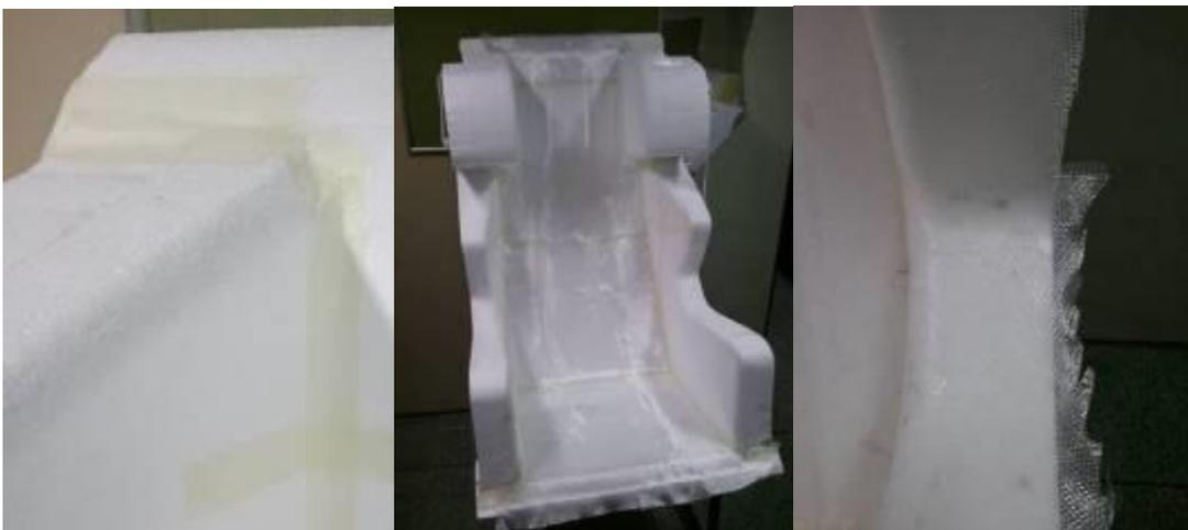
**Figura 51 - Isolamento do isopor® com uso de compósito**
