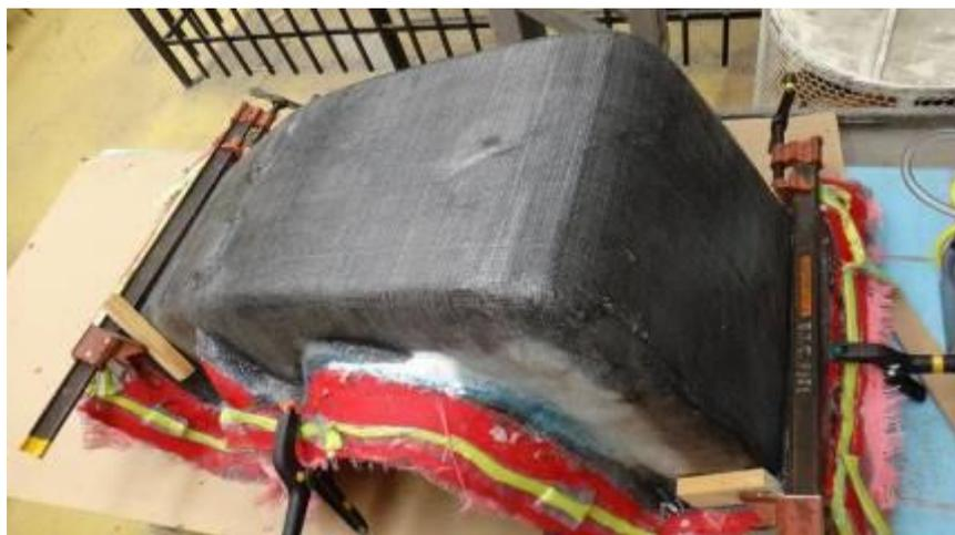
**Figura 92 - Travamento do protótipo para termino de cura**
