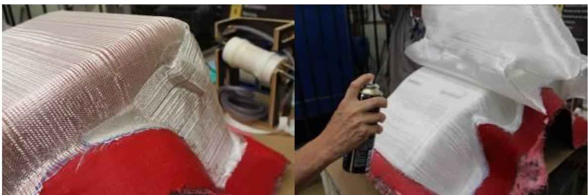
**Figura 82 - Fixação das camadas de fibra de vidro com uso de cola spray**
