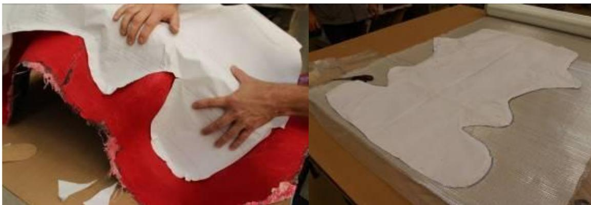
**Figura 80 - Cópia do molde para recortar tecidos e camadas internas da bolsa de vácuo**
