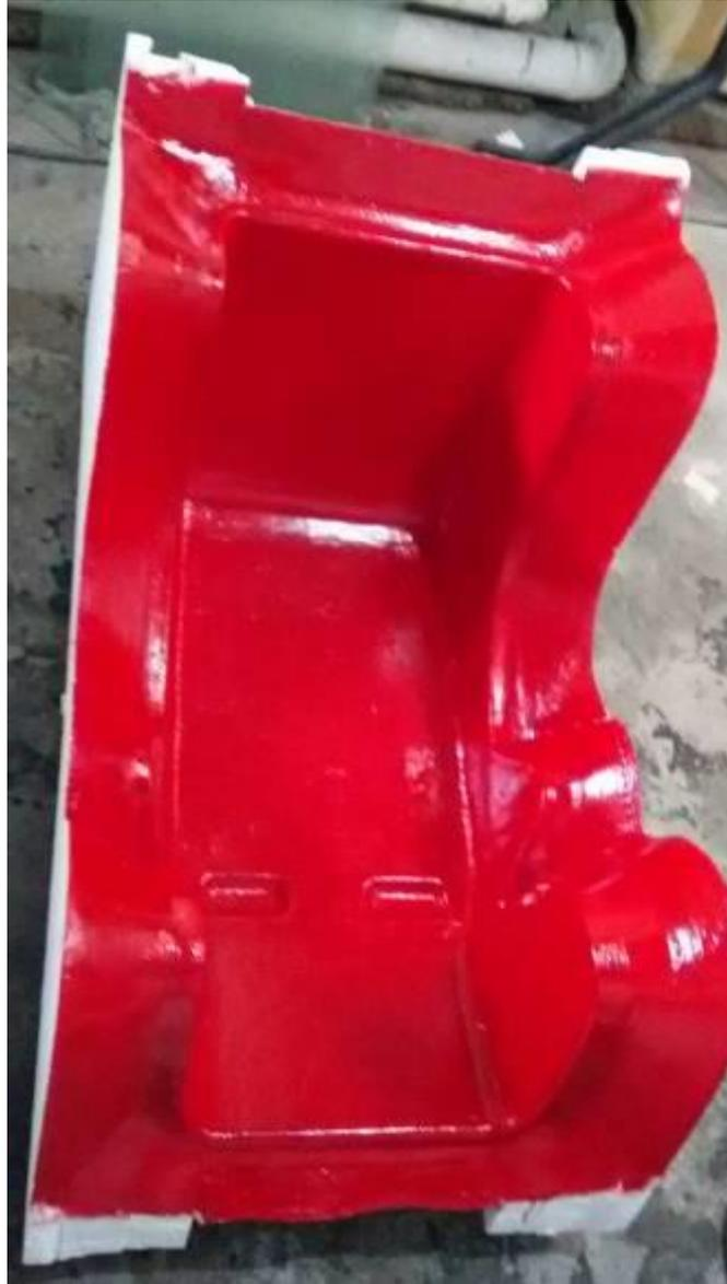
**Figura 76 - Modelo após a aplicação do gel coat**
