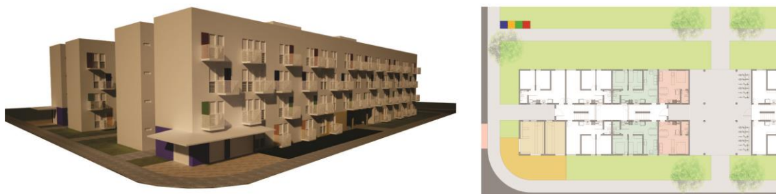
Figura 31 - Perspectiva e planta do Empreendimento Anayde Beiriz. Tipologia térreo+3 “H”, comércio nas esquinas e pilotis no centro. Fonte: SUASSUNA, 2010.
