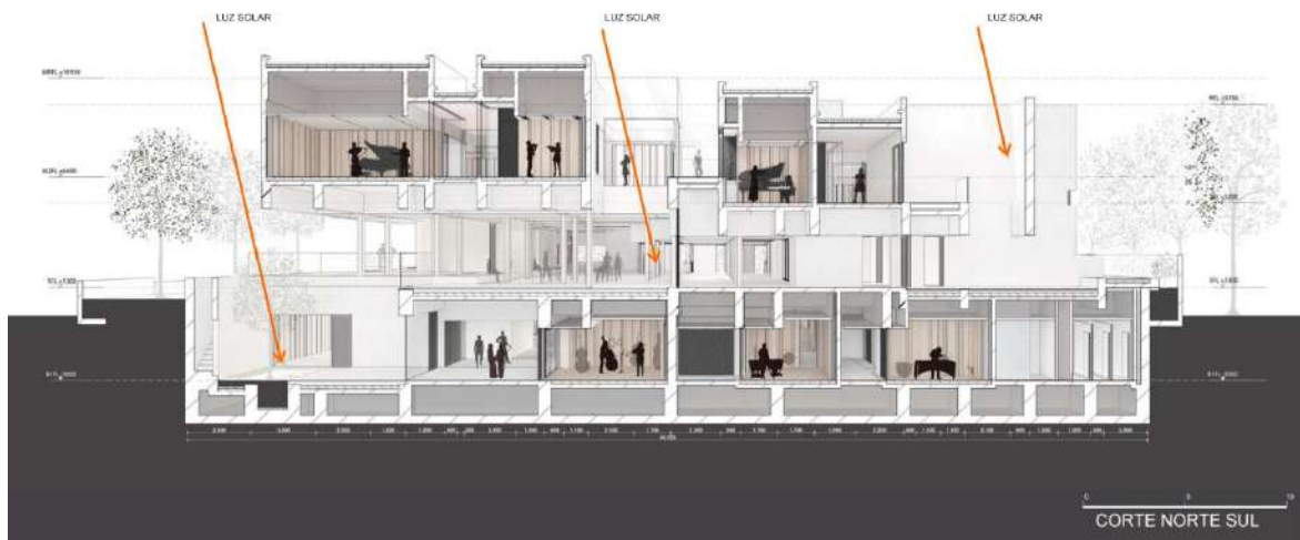
Figura 16 - Corte demonstrando as entradas de luz. Fonte: ArchDaily, editado pela autora.
