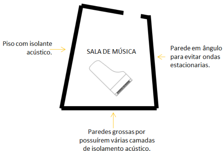
Figura 1 - Planta de sala de aula ideal para o ensino de música. Fonte: Elaborada pela autora.
