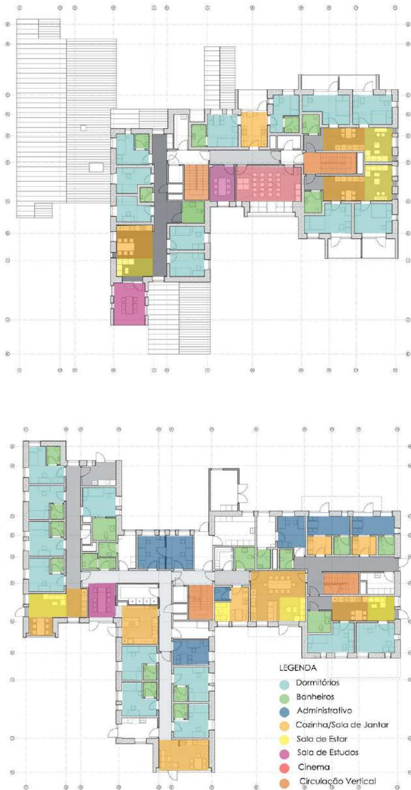
Figura 21 e 22: Setorização primeiro pavimento e pavimento térreo.
