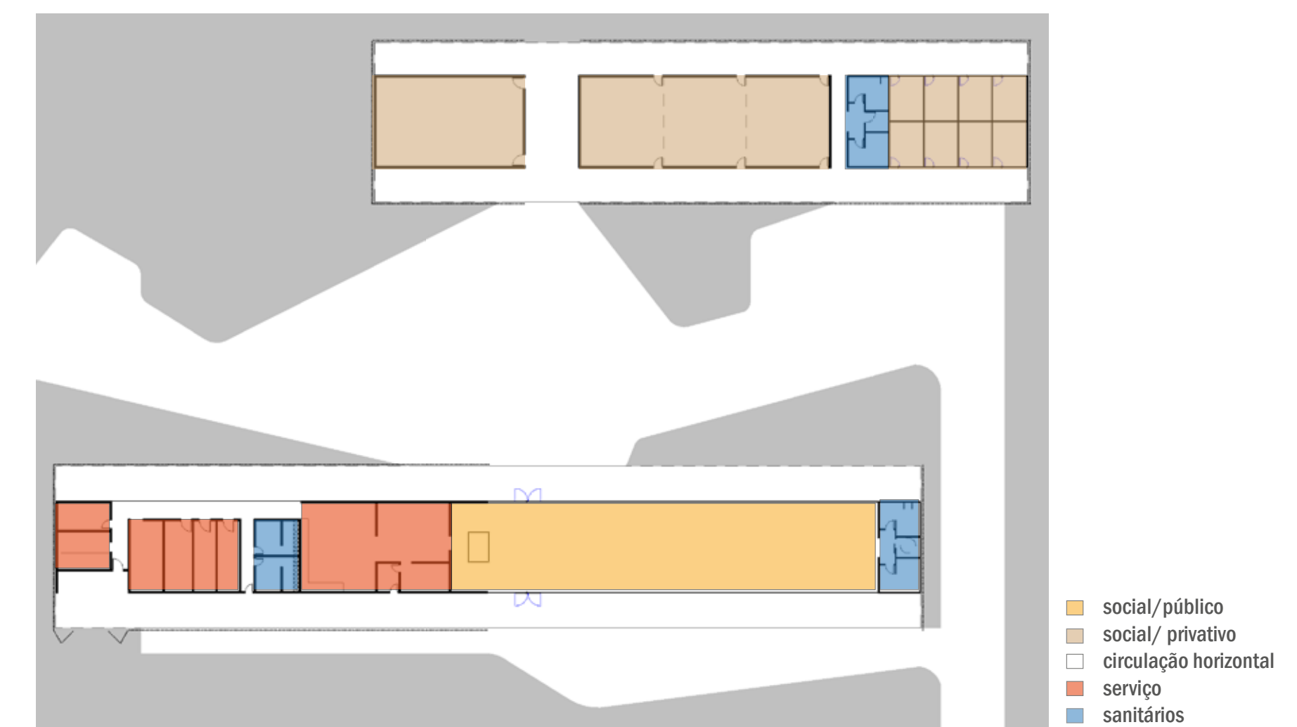
planta esquemática térreo - restaurante e edifício imprensa esc. 1/1000
