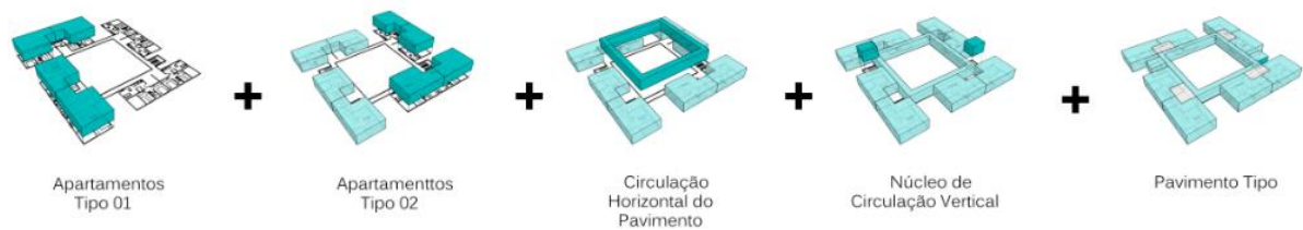
Figura 41 – Diagrama de usos do pav. tipo das unidades de habitação multifamiliar.
