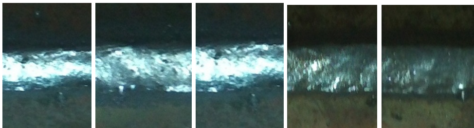
Figura 12 - Imagens Originais, Cordões de solda conformes.
