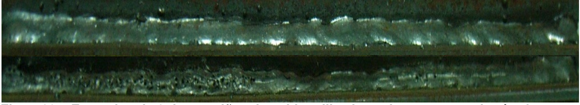
Figura20 – Exemplos de 2 dos cordões de solda utilizados, a imagem superior é referente a solda conforme a inferior a solda porosa.
