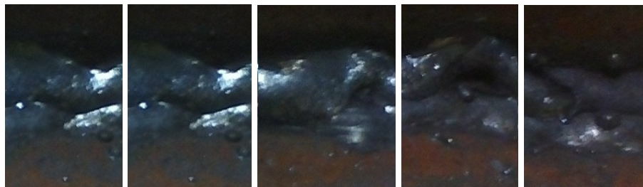
Figura 13 - Imagens originais cordões de solda não conformes.
