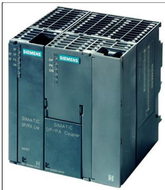
Figura 8 – Exemplo de Gateway Coupler/link da Siemens Fonte: Automation drive (2014).
