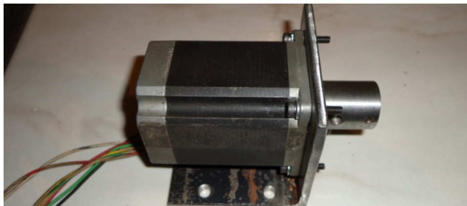
Figura 30 - Suporte confeccionado para adição quarto eixo
