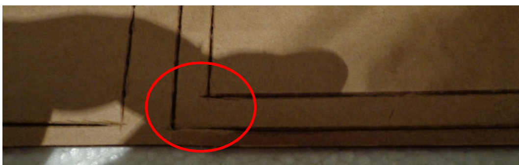
Fotografia 37 - Peça cortada protótipo de papelão, detalhe cruzamento de corte.
