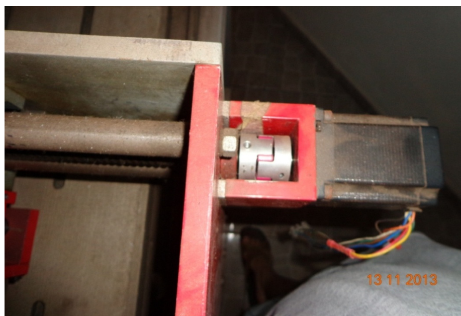
Fotografia 14 - Protótipo de testes fresadora três eixos detalhe do motor eixo X
