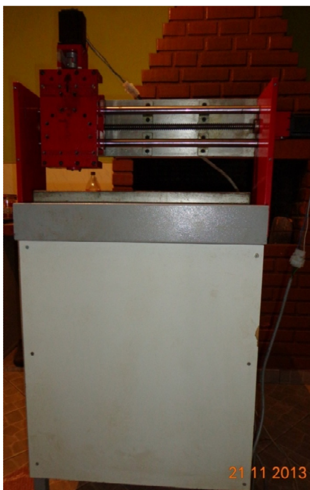
Fotografia 12 - Protótipo de testes fresadora três eixos Vista frontal
