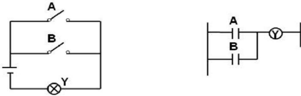
Figura 21 - Circuito equivalente OU e sua representação em Ladder.
