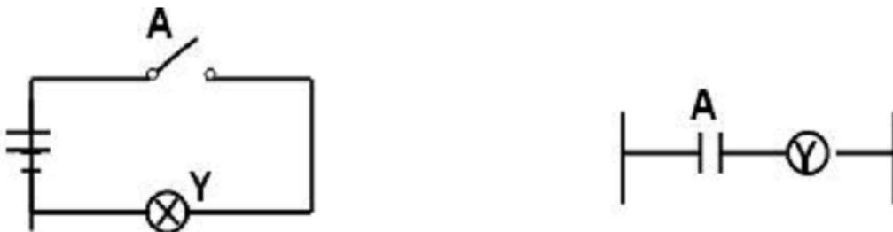
Figura 20 - Circuito equivalente SIM e sua representação em Ladder.
