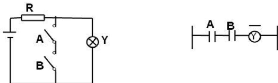
Figura 25 - Circuito equivalente “NÃO E” e sua representação em Ladder.
