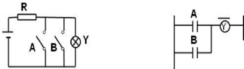
Figura 24 - Circuito equivalente “NÃO OU” e sua representação em Ladder.
