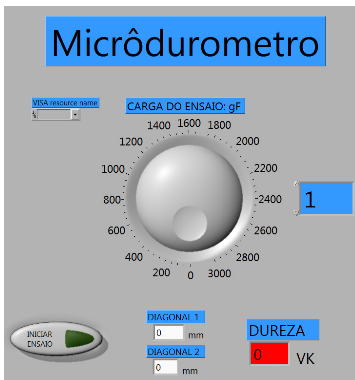
Figura 39 - Tela de interface desenvolvida em LabVIEW para o protótipo do microdurômetro digital (Fonte: autoria própria).
