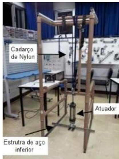
Figura 28 – sistema de ensaio para avaliação da resistência mecânica do equipamento.
