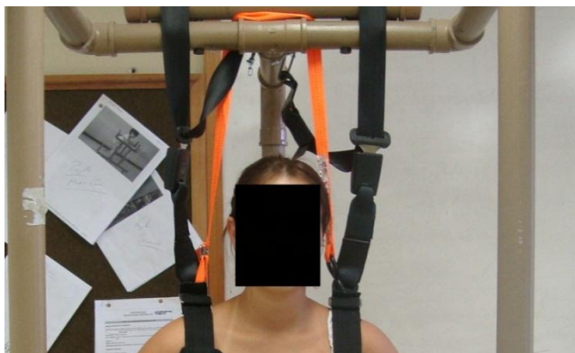
Figura 49 - Sistema de sustentação com a inserção de fita para aumento da segurança do usuário.
