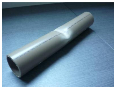
Figura 44 - Deformação ocorrida no PVC após o ensaio de flexão
