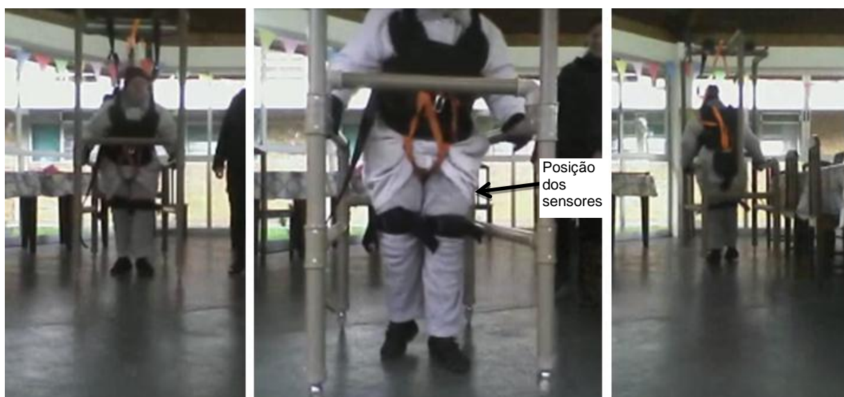
Figura 41-Avaliação Biofeed® com o andador desenvolvido
