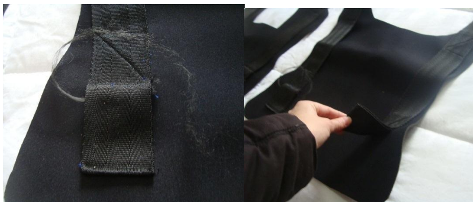
Figura 22 – Fragilidade apresentada na costura realizada no neoprene®
