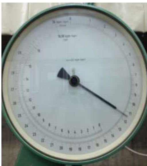
Figura 36 - CP4 - Resultado obtido pelo relógio (Erel = 11,4 kpm) Fonte: Autoria Própria
