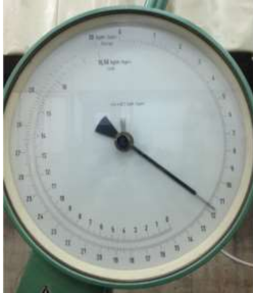
Figura 26 - CP2 - Resultado obtido pelo relógio (Erel = 11,6 kpm) Fonte: Autoria Própria
