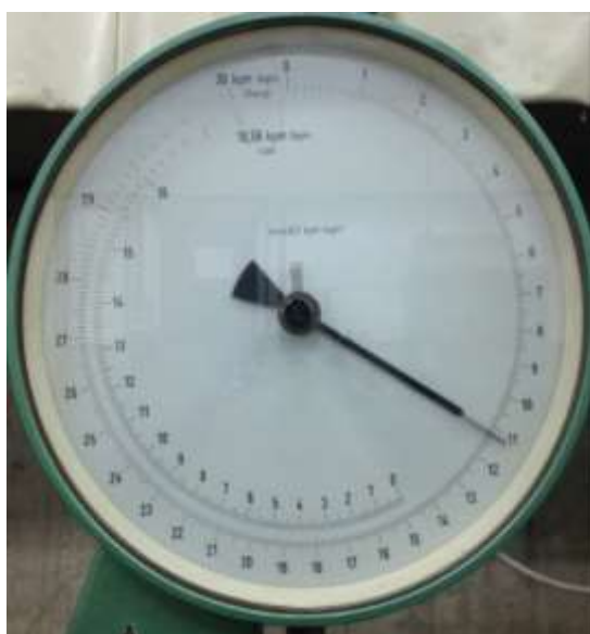
Figura 31 - CP3 - Resultado obtido pelo relógio (Erel = 11,2 kpm) Fonte: Autoria Própria
