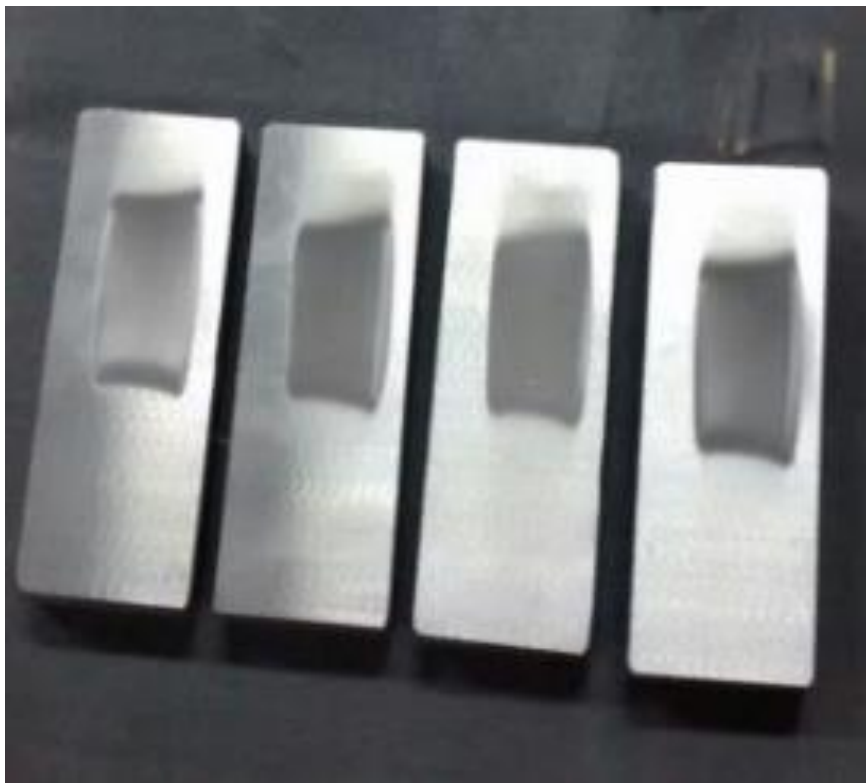
Figura 31: Marcas de desgaste após ensaio do aço AISI 1045 recozido. Fonte: Próprio autor.
