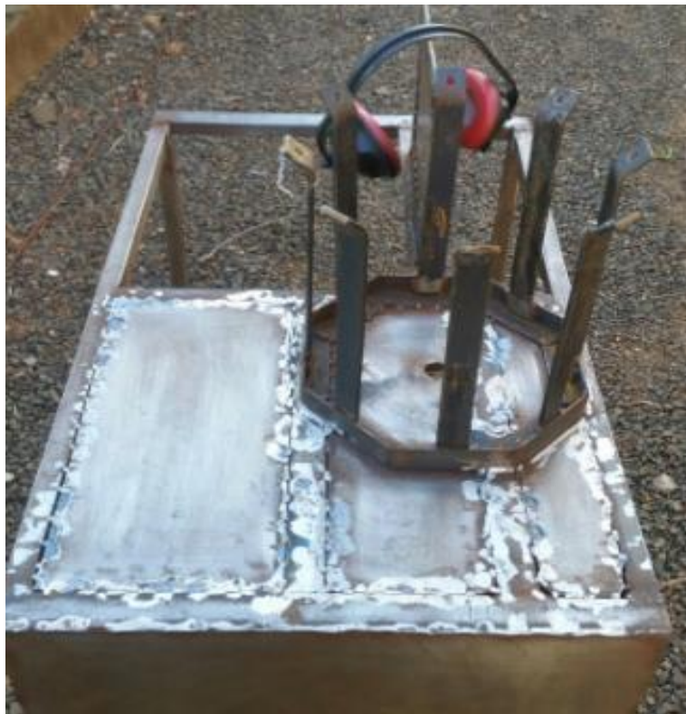
Figura 15: Aspecto dos cordões de solda após lixamento. Fonte: Próprio autor.
