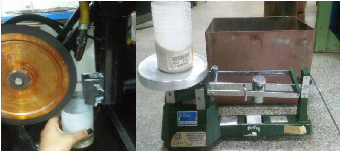
Figura 21: Medição da vazão de abrasivo. Fonte: Próprio autor.
