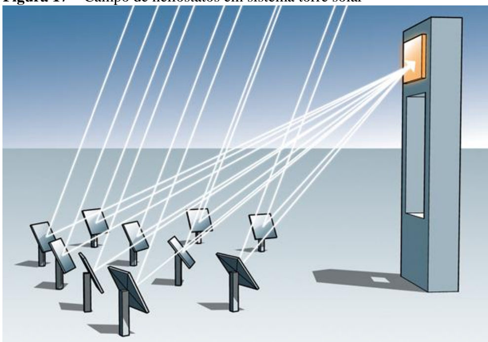
Figura 17 – Campo de heliostatos em sistema torre solar
