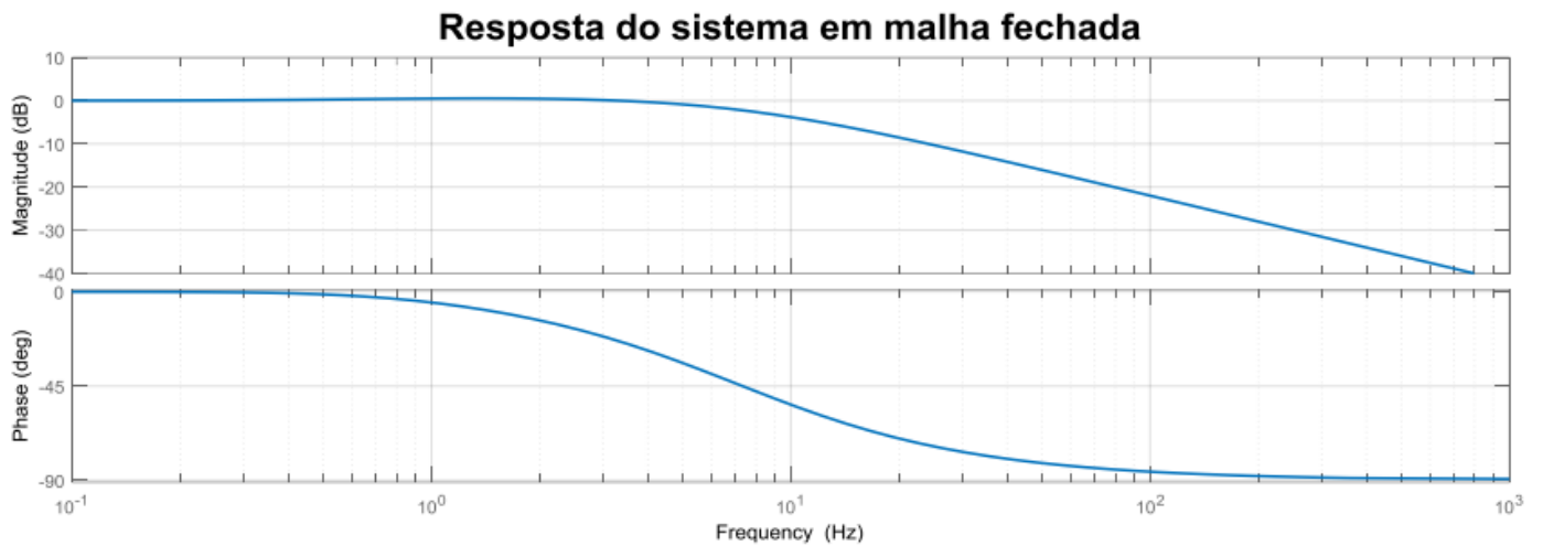
Figura 36 - Resposta em frequência do sistema em malha fechada - malha de tensão FB Fonte: Próprio autor.
