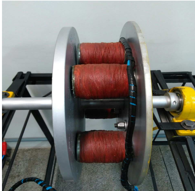
Figura 16: Bobinas de campo, com tratamento à base de resina, montadas no estator do freio.
