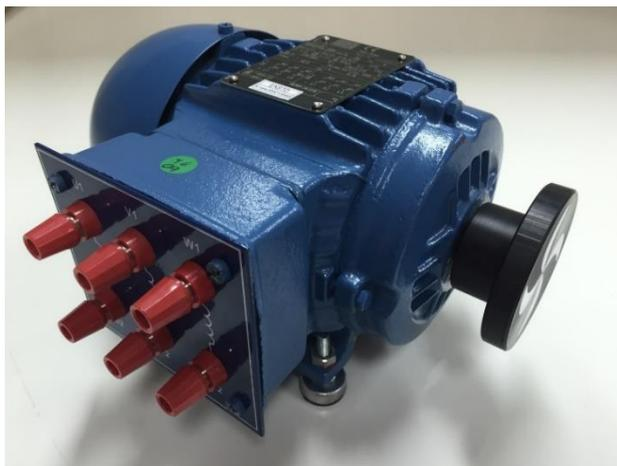
Figura 18 - Motor de Indução
