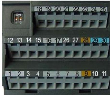
Figura 17 - Terminais de controle MICROMASTER 440
