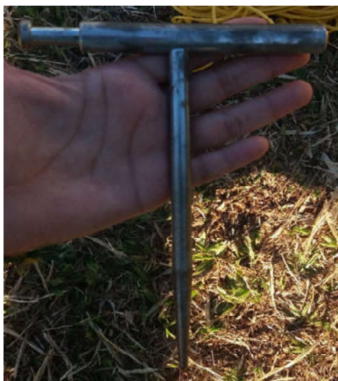
Figura 13- Eletrodo auxiliar para medição com o Terrômetro
