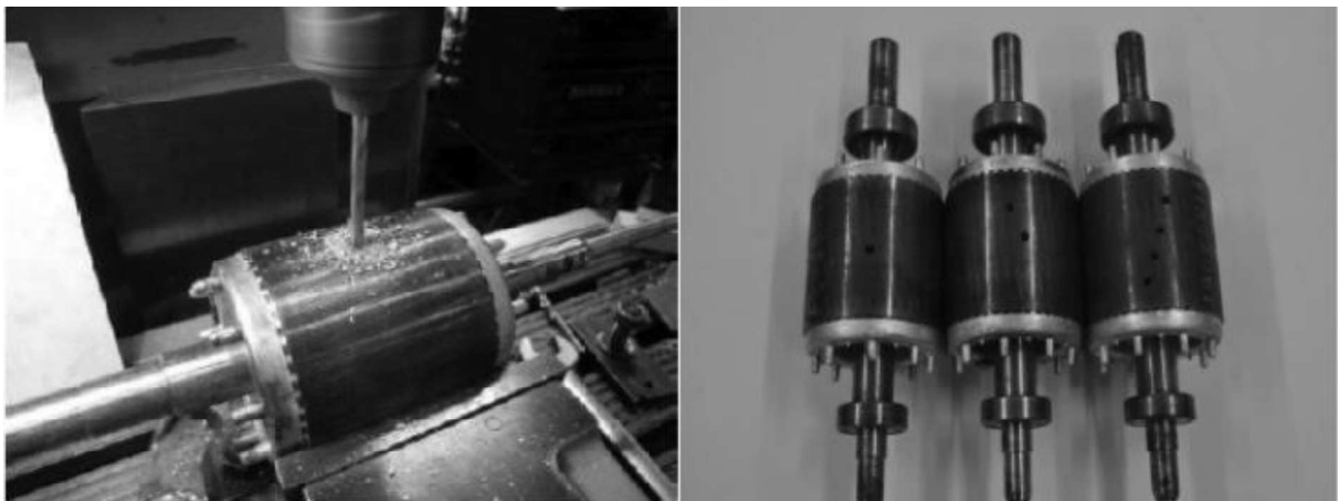
Figura 11 - Rotor com quebra forçada das barras
