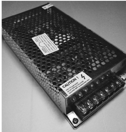
Fotografia 11 – Fonte eletrônica estabilizada.
