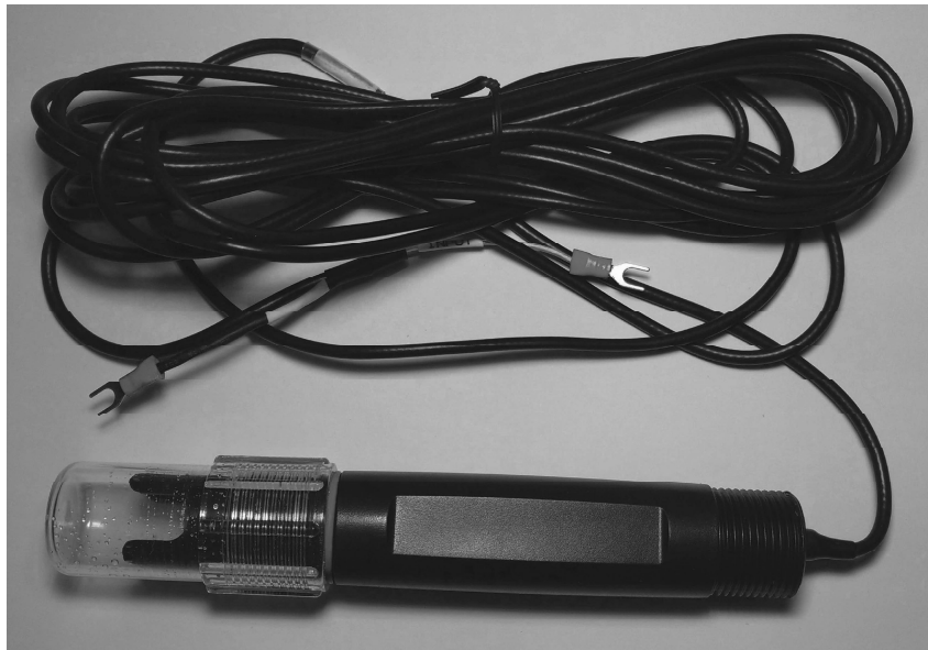
Fotografia 2 – Eletrodo de ORP, eletrodo cominado
