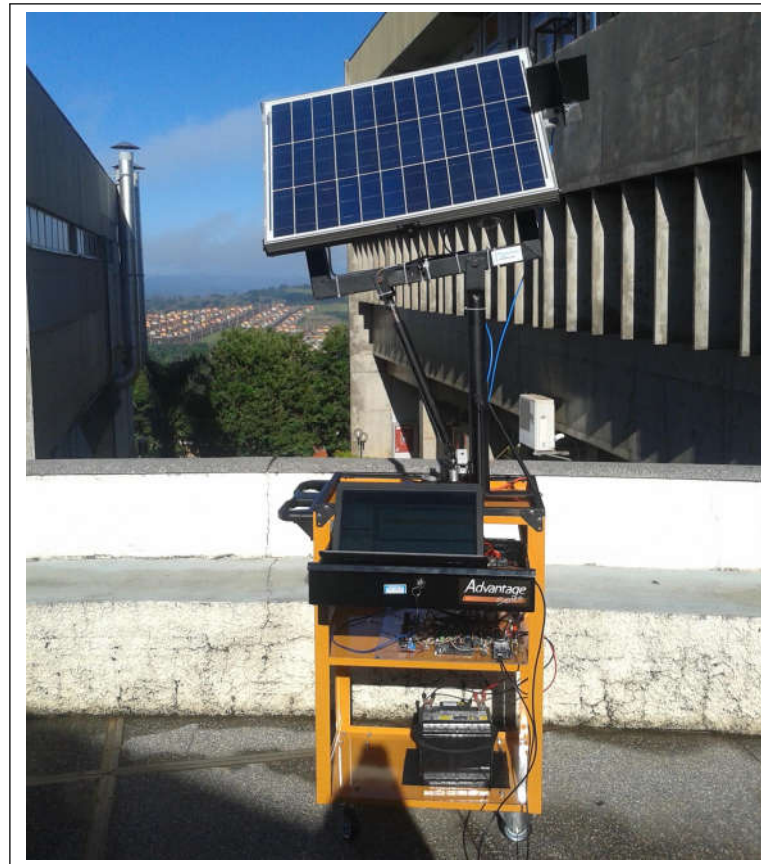
Figura 15 – Estrutura móvel para placa fotovoltaica.
