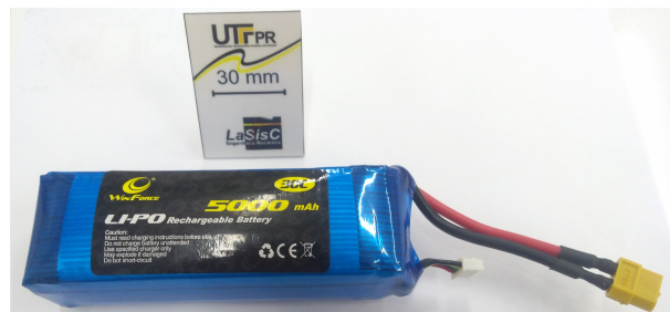
Fotografia 2 – Bateria de Lithium-polymer utilizada no trabalho.
