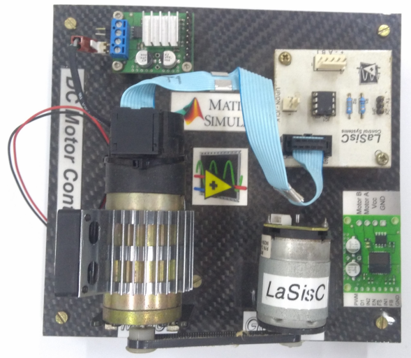
Fotografia 4 – Bancada do motor CC onde também se encontram o drive de potencia e o encoder.
