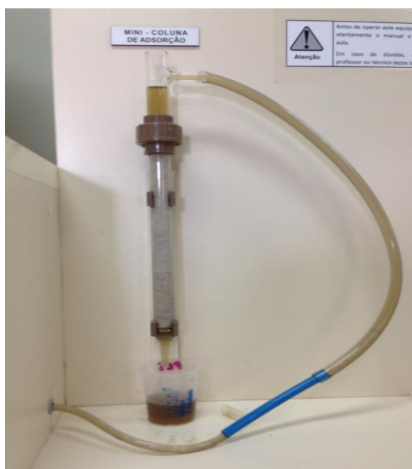
Figura 2 – Experimento de adsorção em coluna de leito fixo.
