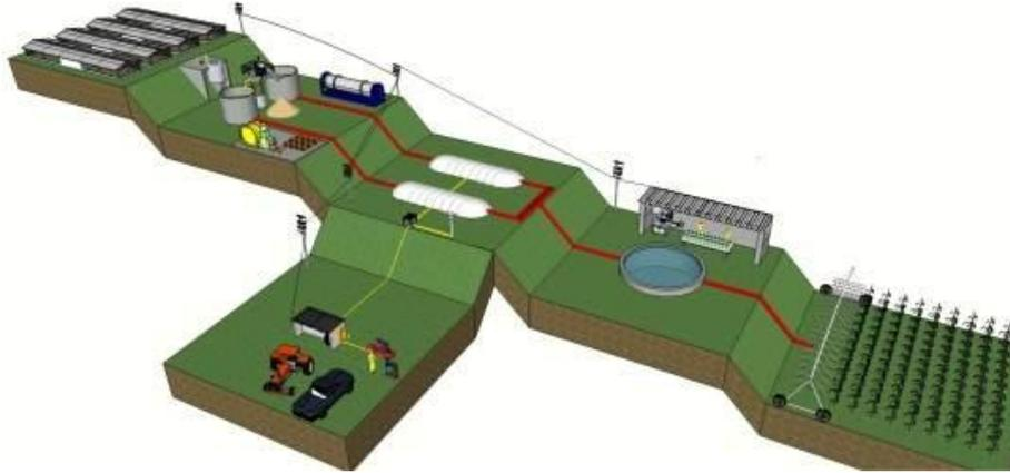
**Figura 3 – Sistema de utilização do biogás e subprodutos e partir do biodigestor de Aeres.**
