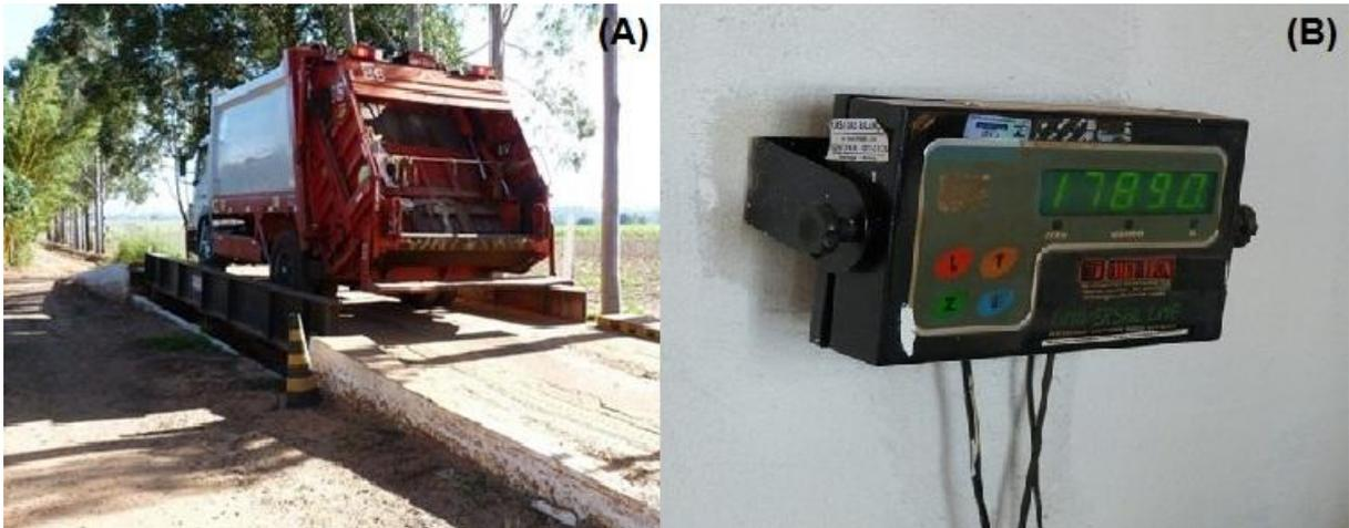
**Figura 32 – Balança do Aterro Sanitário de Paranavaí. (A) Balança Pesando um Caminhão Prensa de Coleta de Lixo; (B) Visor da Balança.**
