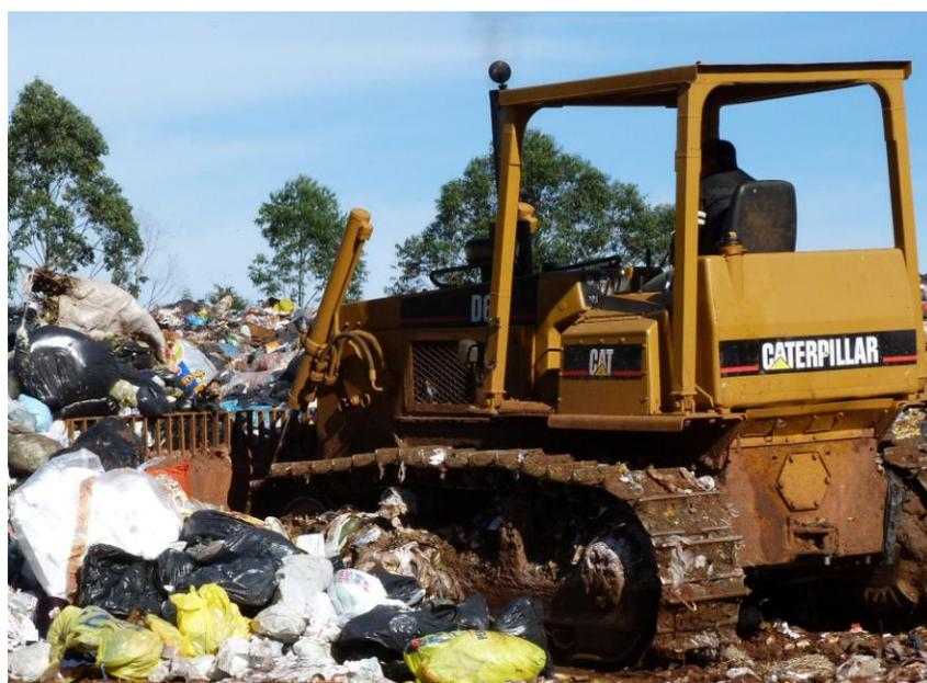
**Figura 27 – Trator esteira modelo D6 que permanece no Aterro Sanitário de Paranaíba.**
