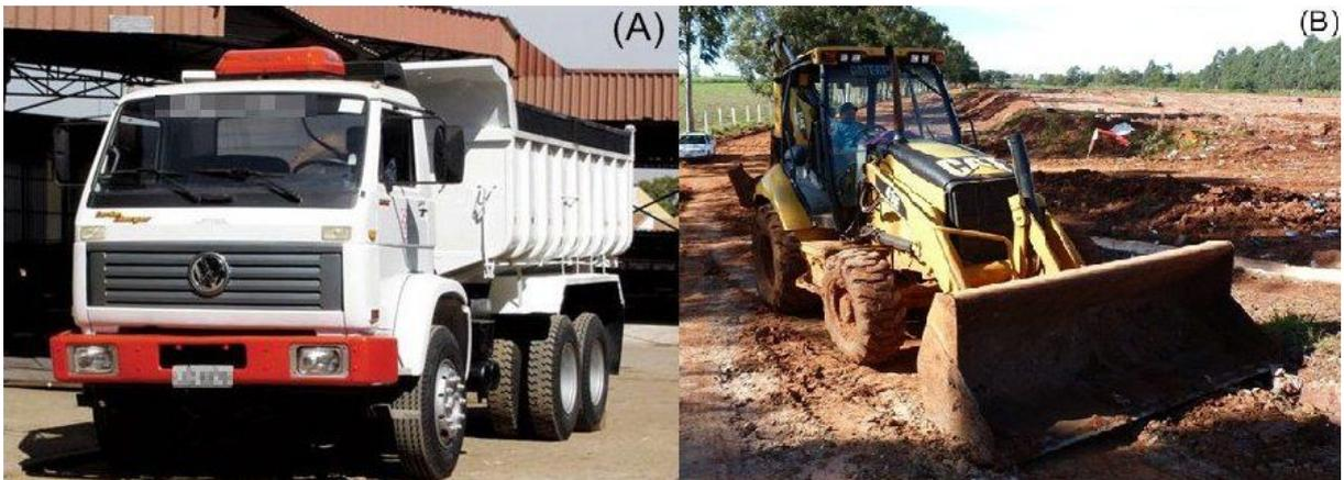
**Figura 28 - Equipamentos Auxiliares do Aterro Sanitário de Paranavaí. (A) Caminhão Basculante; (B) Retroescavadeira.**
