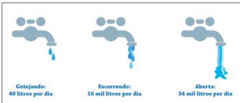
Figura 23 - Quantidade de água gasto em relação ao funcionamento de uma torneira Fonte: Cagno, 2013.
