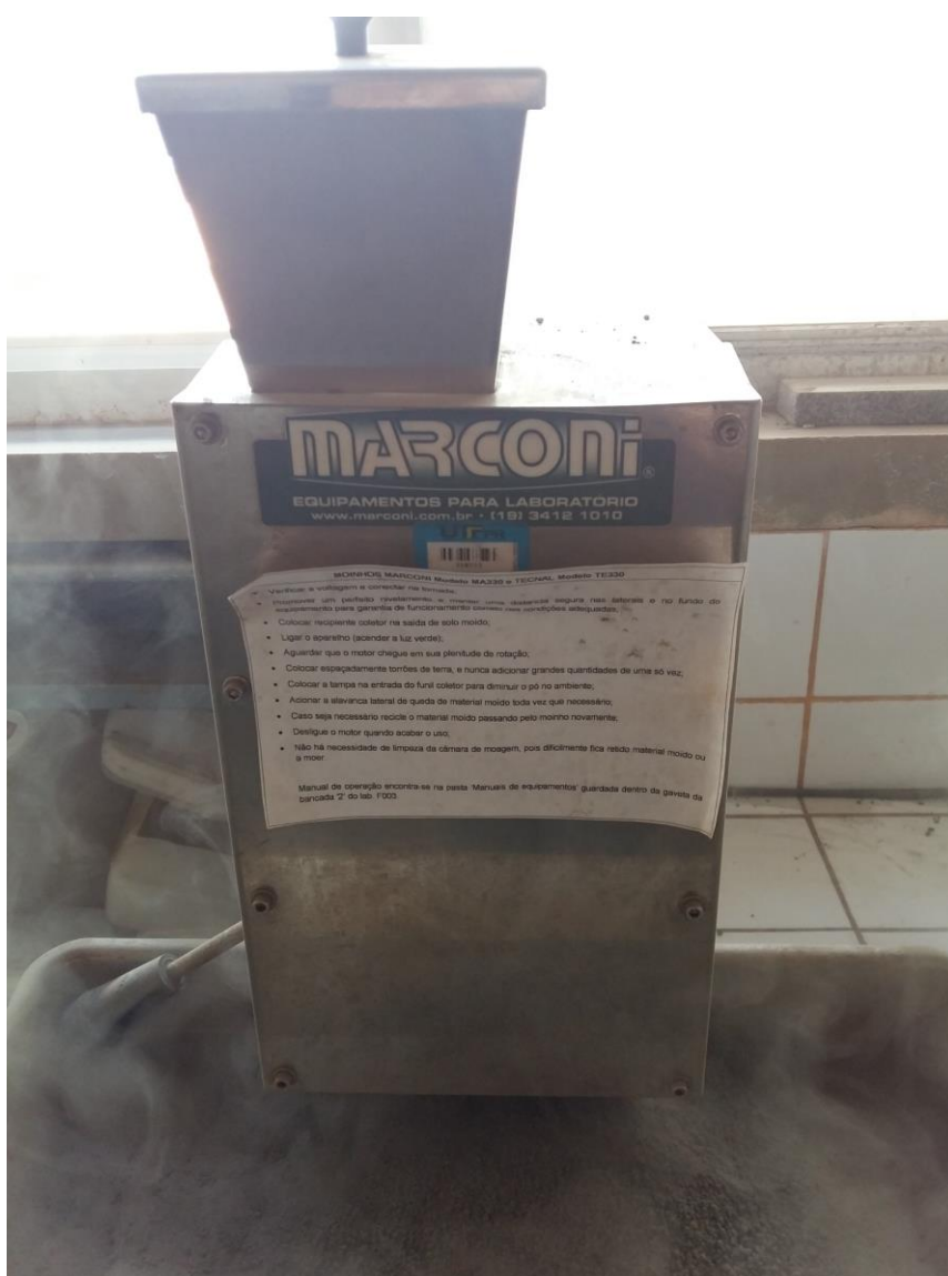
Figura 1 - Lodo seco sendo triturado por moinho da marca Marconi
