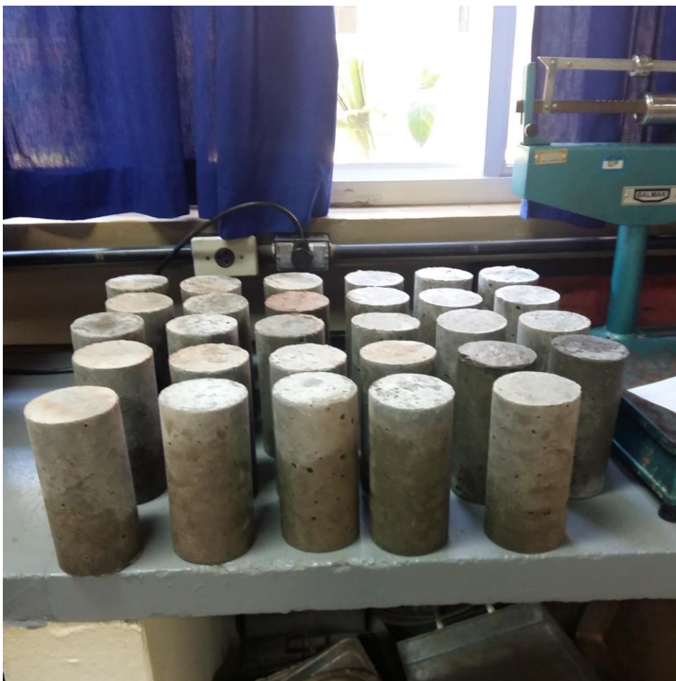
Figura 2 - Corpos de prova após a retirada do molde.
