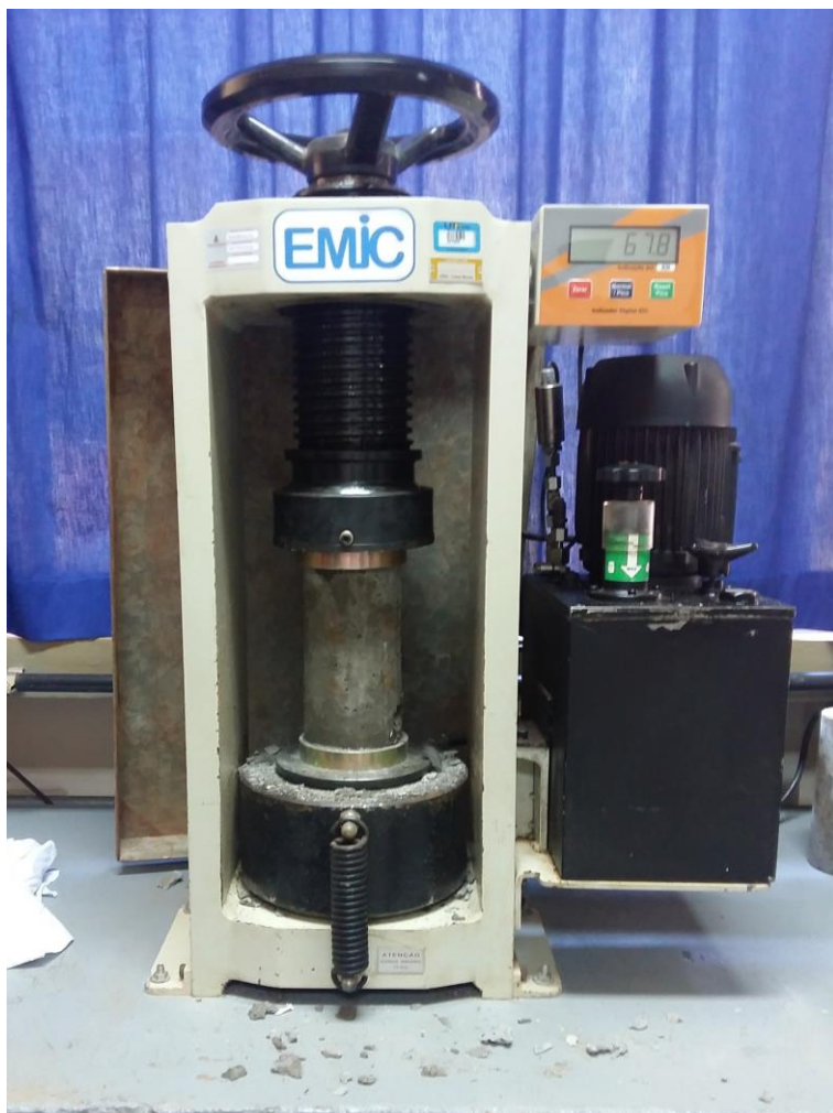
Figura 3 - Prensa de compressão realizando compressão em um corpo de prova.
