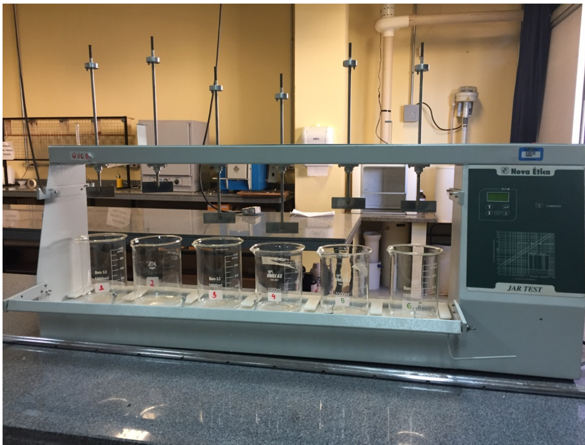
Figura 2 - Instrumento de jar test utilizado para a realização dos ensaios. Fonte: Elaborada pelo autor.
