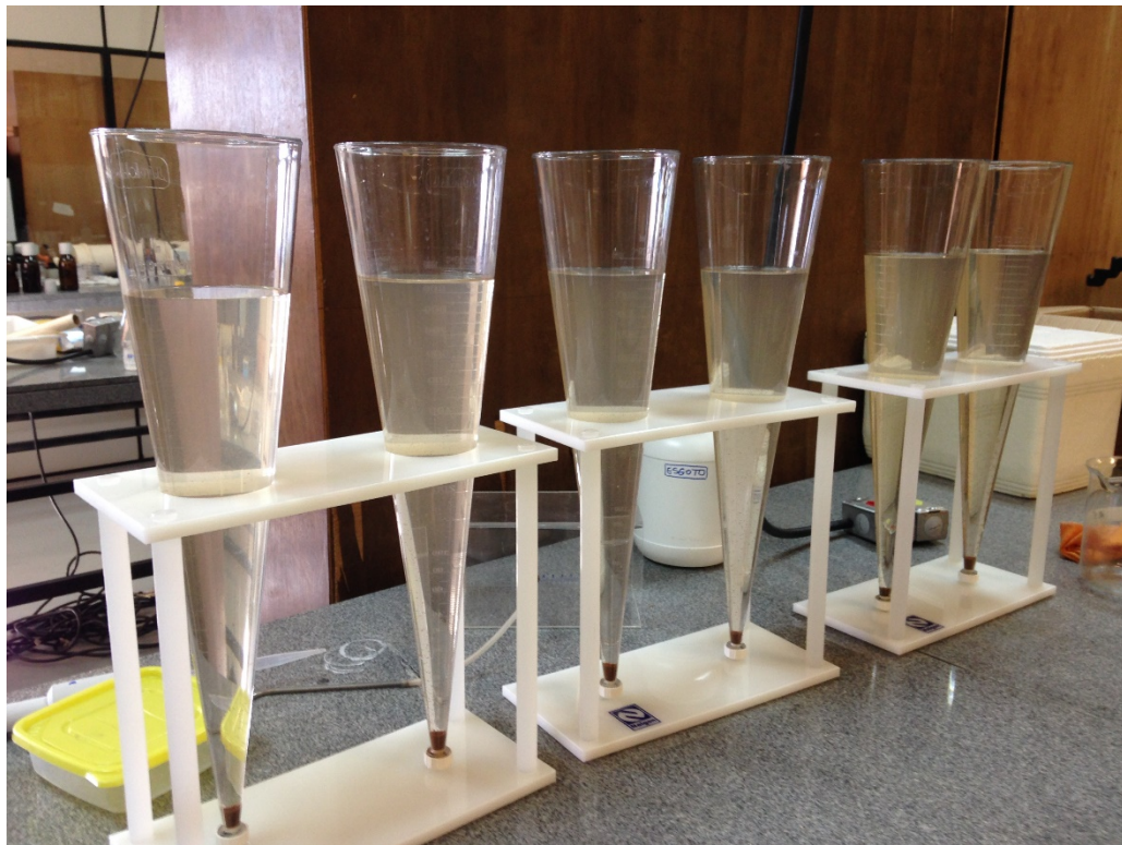
Figura 4 - Cones Imhoff usados para avaliar a geração de lodo no tratamento.
