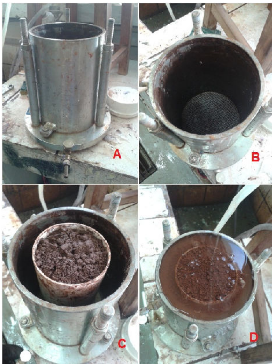
Figura 10 – Preparação do permeâmetro para execução do ensaio. A – Visão lateral do permeâmetro. B – Visão superior do permeâmetro. C – Permeâmetro com a amostra do solo em seu interior. D – Permeâmetro preparado com parafina ao redor da amostra de solo, sem percolação de água.
