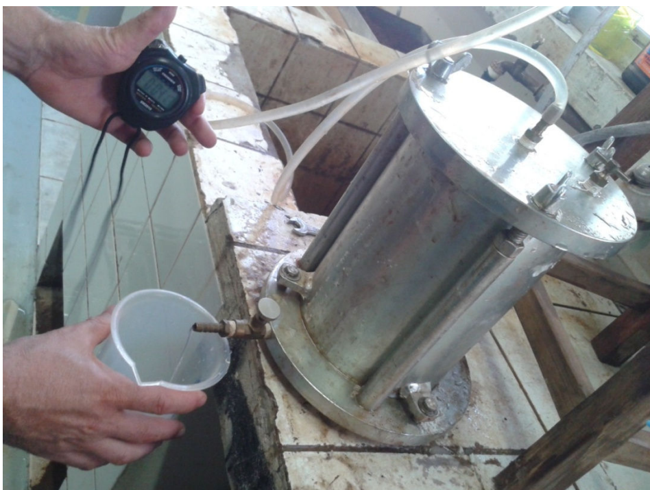
Figura 12 – Medição da carga hidráulica em determinado tempo. Fonte: Autoria própria (2015).
