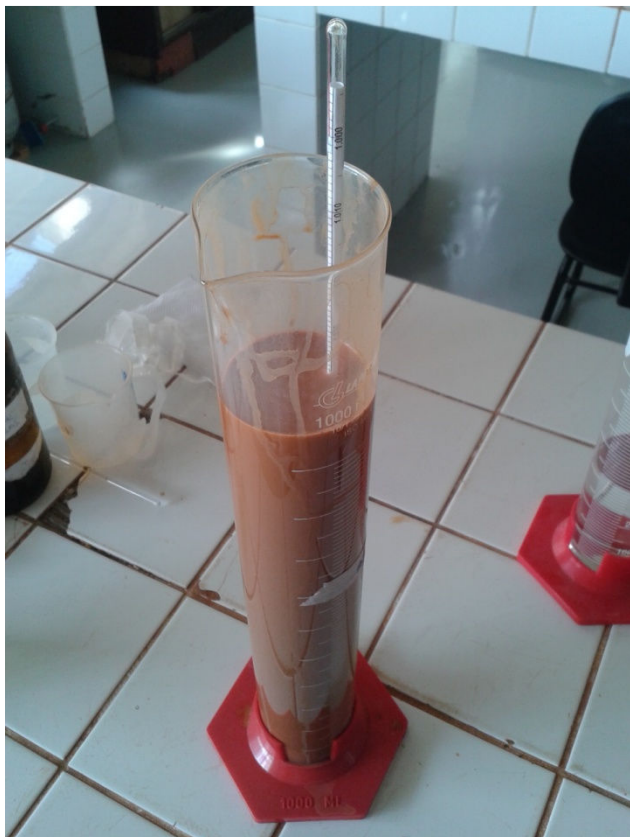
Figura 14 – Proveta de 2 l com densímetro mergulhado na amostra de solo. Fonte: Autoria própria (2015).
