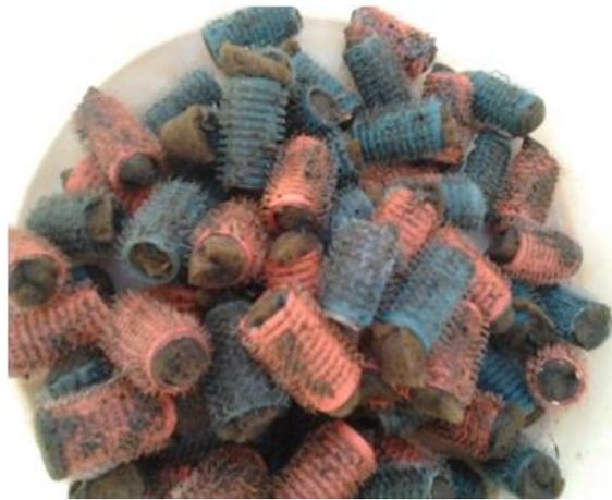
**Figura 3 - Meio suporte: espuma de poliuretano, envoltas por estruturas de polipropileno**
