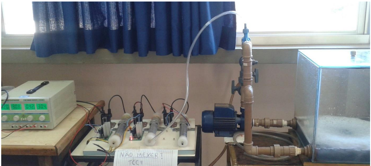
Figura 3 – Aparato utilizado no tratamento do efluente têxtil. Fonte: Autoria própria (2015).
