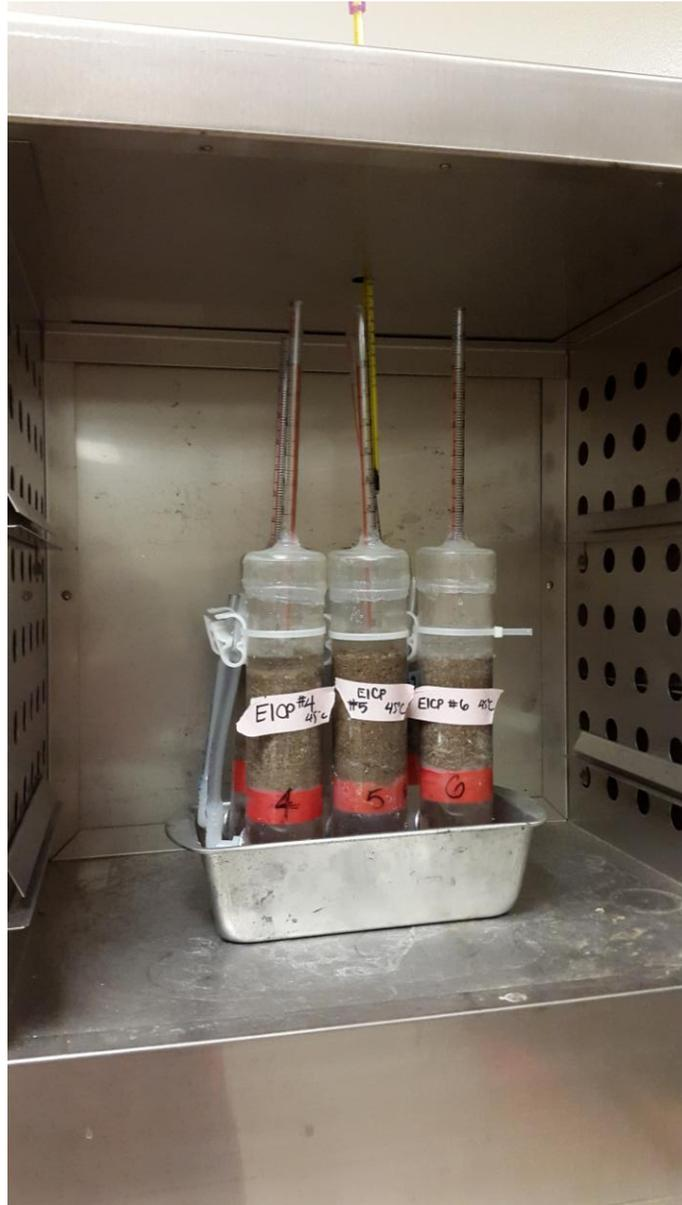
**Figura 2 - Colunas na estufa à temperatura de 45°C.
